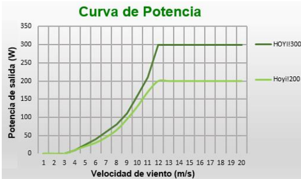
Figura 3.8 Curva de potencia del aerogenerador HoYi 200
