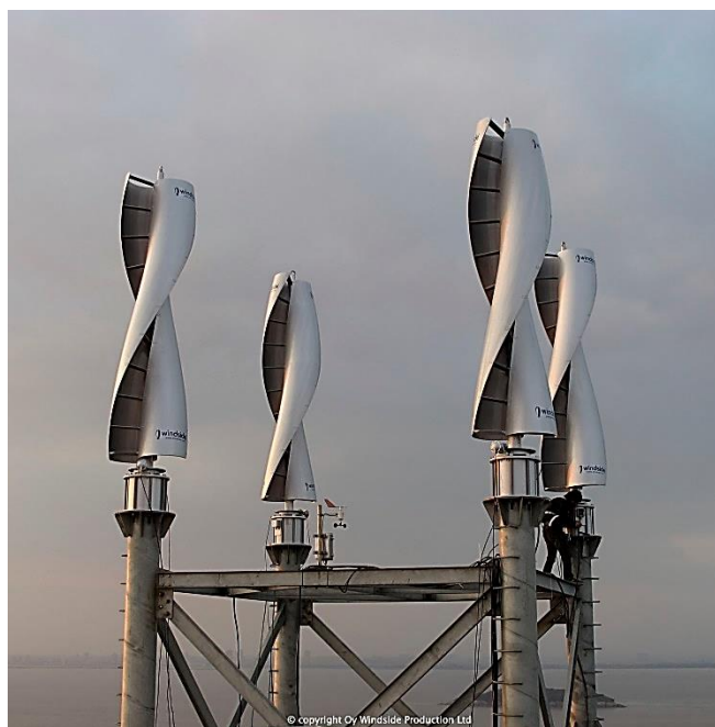
Figura 2.3 Aerogenerador Savonius en vía primaria
