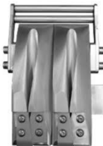
Figura 24. Formador de envase para productos stickpack 34 .
