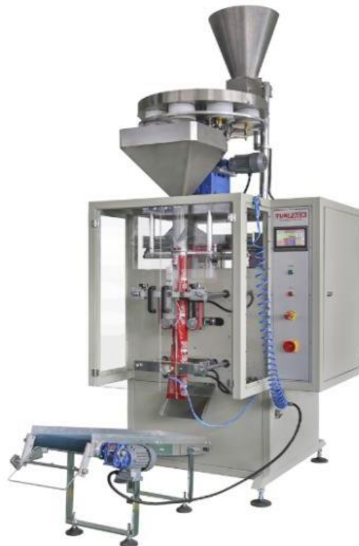
Figura 52. Máquina de envasado vertical VFFS para productos de grano /llenado de vasos volumétricos 107 .
