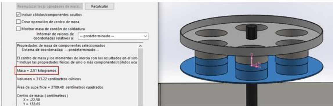
Figura 64. Cálculo de masa por software tomando la densidad del acero AISI 316 de 8.0 g/cm 3 (elaboración propia).
