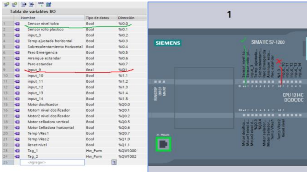
Figura 125. Configuración de variables en PLC (elaboración propia).
