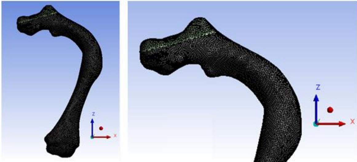
**Figura IV. 7.-** Discretizado del modelo del sistema biológico en el ANSYS Workbench®
