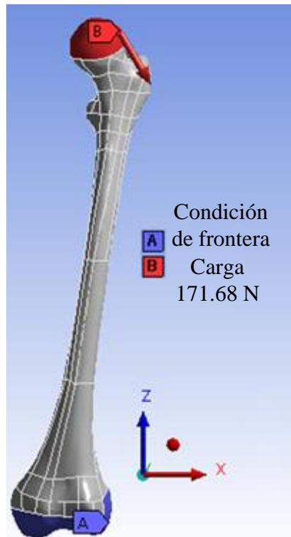
**Figura III.13.-** Aplicación de carga y de condiciones de frontera en el modelo 3D
