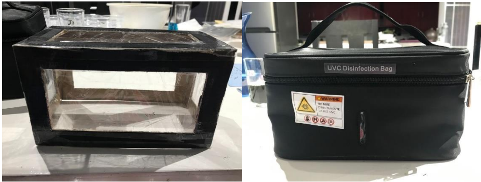
Figura 3.18. Caja con celofán y equipo UV-C Disinfection Bag (Bright solutions 230-255 nm), (Elaboración propia, 2021)
