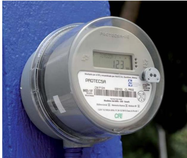
Figura 6.- Medidor inteligente tipo AMI (tomado de [Gómez et al.,2015]).
