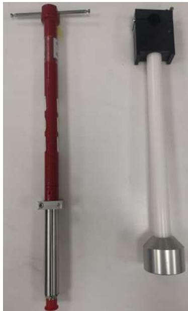
Figura 4.16: Antena dipolo DB4 con su soporte.
