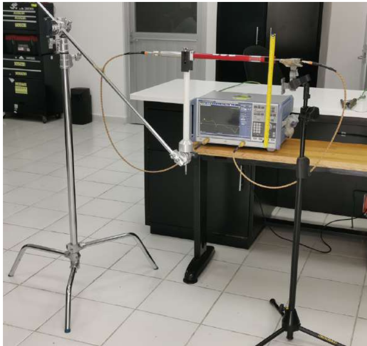
Figura 4.17: Equipo montando para la medición de la antena dipolo.
