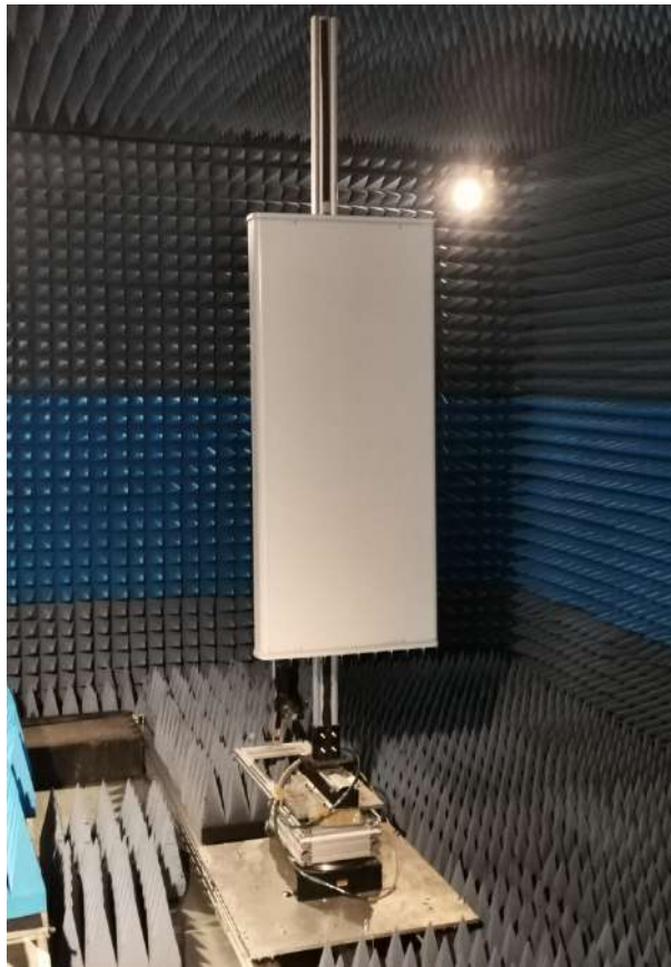
Figura 4.22: Antena de panel montada en el mástil dentro de la cámara anecoica.
