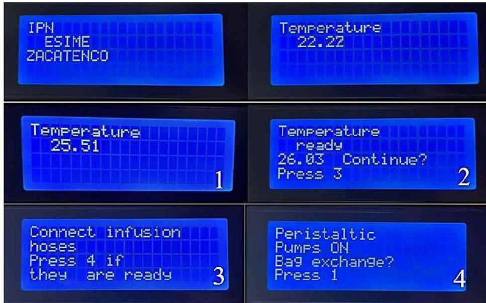
Fig. I.24 Menú del proceso principal de la máquina cicladora para DPA [I.16]
