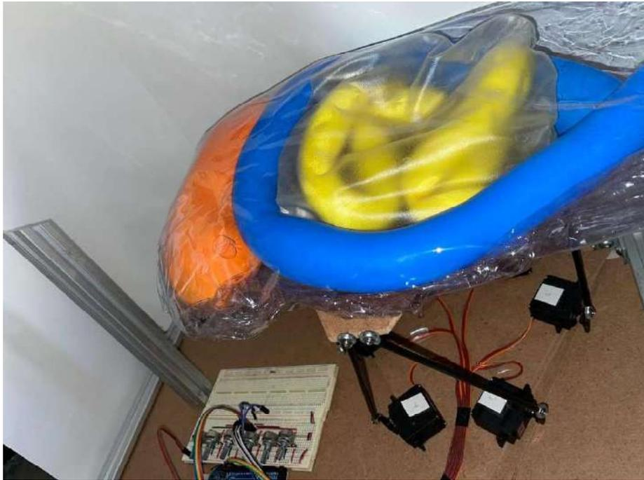
*Fig. III. 33 Ensamblado de plataforma Stewart con cavidad peritoneal.*
