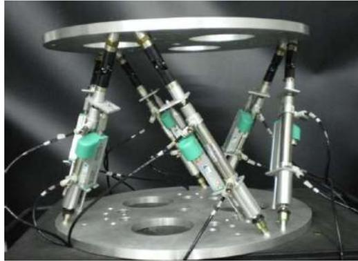
Fig. II. 11 Plataforma Stewart controlada por pistones [II.11]
