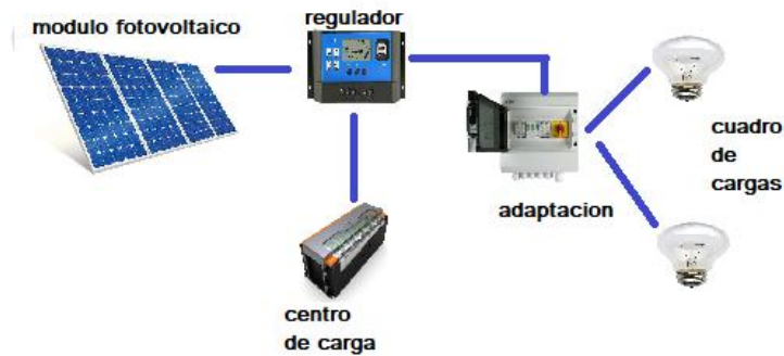
Figura 12. Sistema fotovoltaico aislado.
