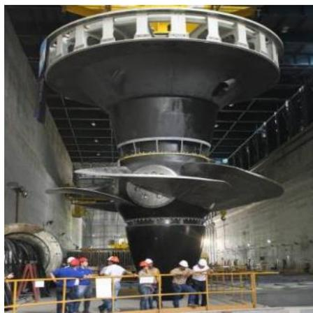
**Figura 1.24 Turbina Kaplan.**
