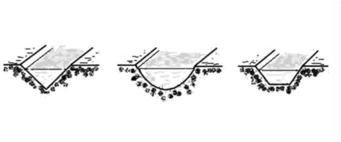
**Figura 1.12 Diferentes tipos de secciones transversales de canales**
