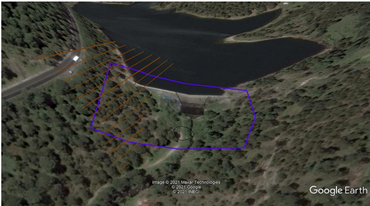
**Figura 3.6 Visualización de las curvas de nivel creadas en Global Mapper en Google Earth pro en el área de estudio para la micro central.**
