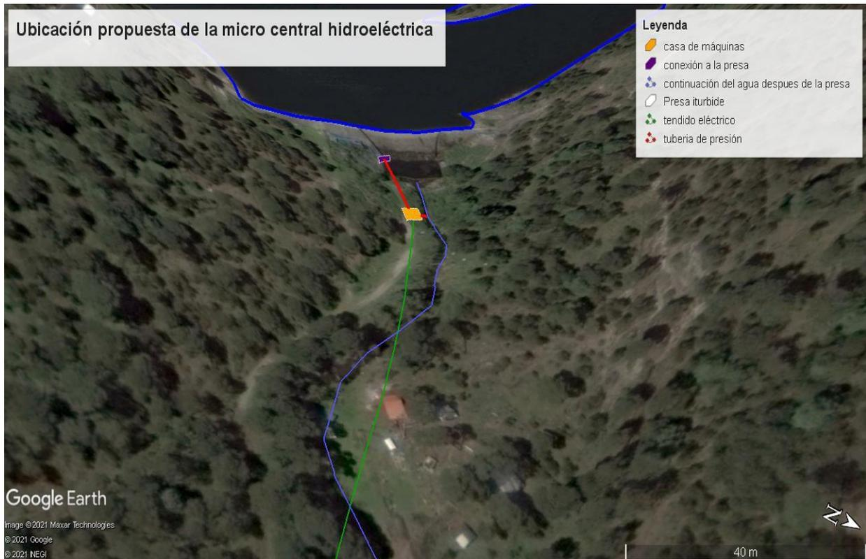
**Figura 3.7 Ubicación propuesta para la instalación de la micro central hidroeléctrica.**
