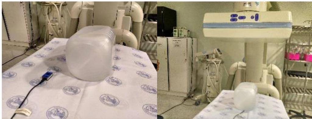
**Figura 24. Colocación de dosímetros para calibración. A la izquierda arreglo para lectura de kerma en aire; a la derecha arreglo para lectura de dosis de entrada a superficie. Se uso un bidón lleno de agua corriente para aproximar el tejido humano.**
