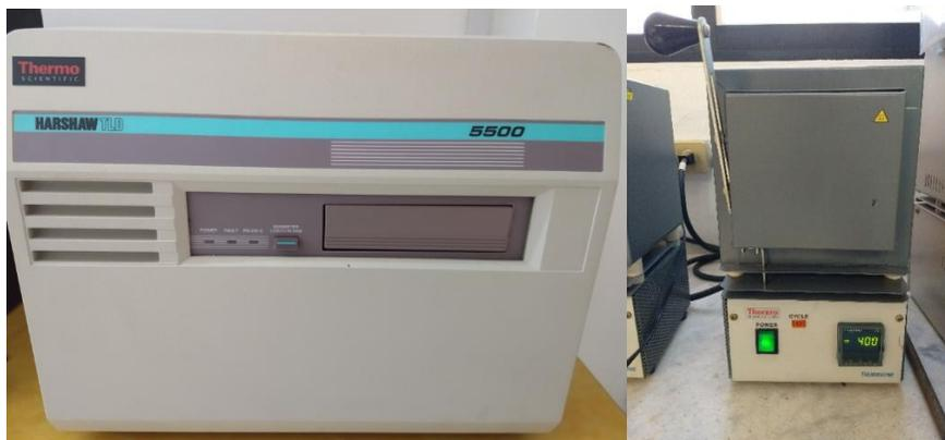
**Figura 22. Izquierda, equipo de lectura para los dosímetros Harshaw 5500. Derecha mufla durante tratamiento térmico.**
