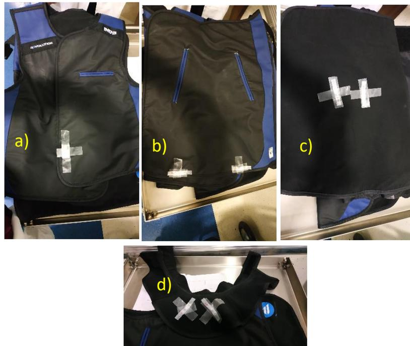
**Figura 29. Posicionamiento de dosímetros en, a) chaleco parte exterior, b) falda parte exterior (rodillas), c) falda parte interior (gónadas), y c) collarín para interior (tiroides).**
