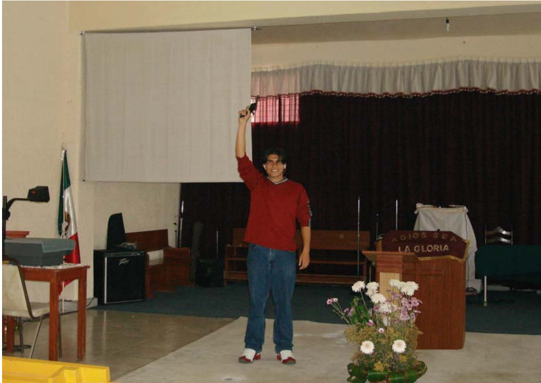
Foto 2.2 Disparo con pistola de salva para obtener una señal de prueba de tipo impulsivo.
