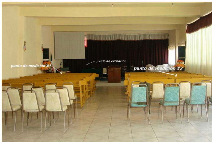
Foto 2.1 Identificación de los puntos de prueba.
