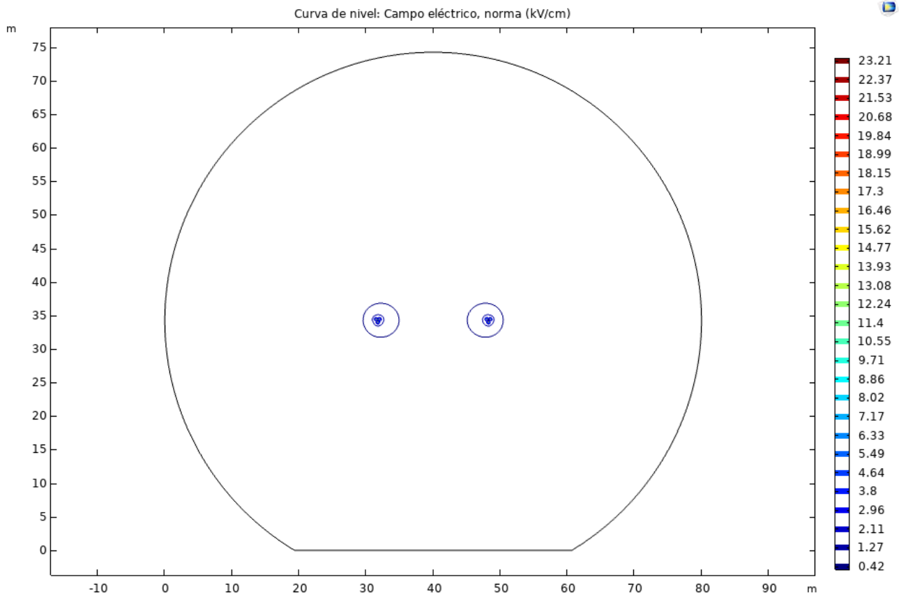
Figura 4-6.-Líneas equipotenciales de campo eléctrico y máximo gradiente en configuración 3x1272MCM a \pm 500 kV C.D.
