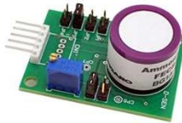
Figura 10. Transductor “EM - FECS” y Sensor FIGARO “FECS44 -100” “ver anexo [E]” [19].
