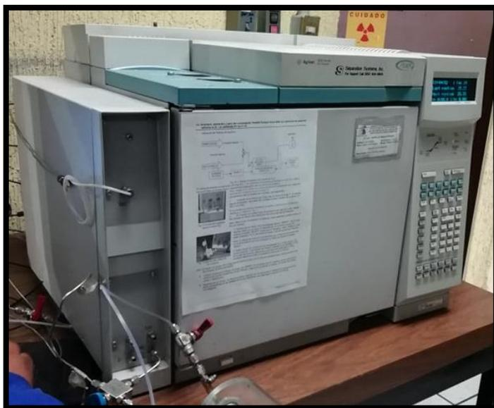
Figura 25. Cromatógrafo de gases.
