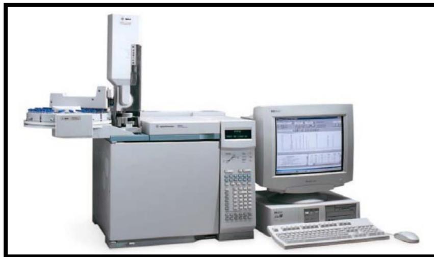
Figura 24. Equipo para cromatografía de gases/espectroscopia de masas (GC-MS).
