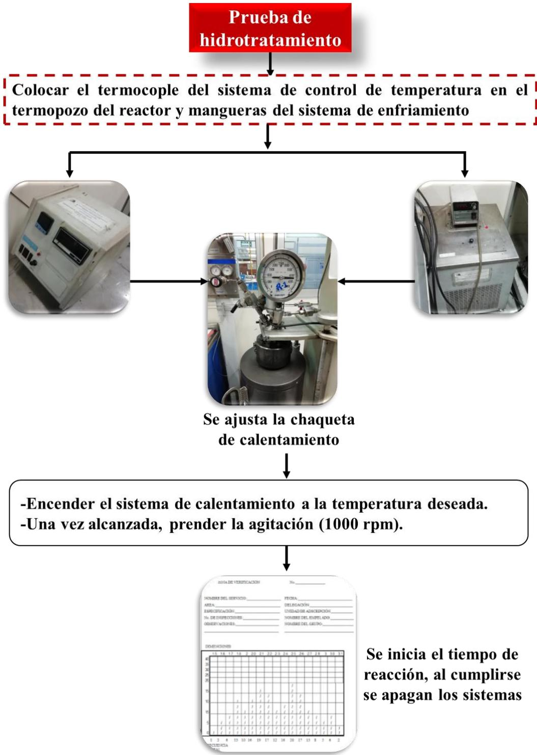
Figura 17. Diagrama de prueba de hidrotratamiento.
