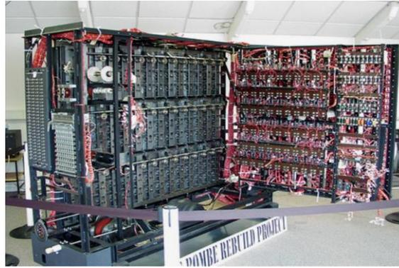
**Figura 6. Máquina “Bombe” diseñada por Alan Turing [16]**
