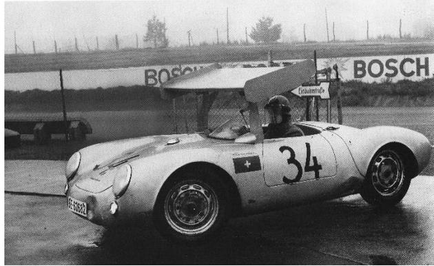
**Figura II.2.-** Porsche Spyder con el alerón diseñado por May
