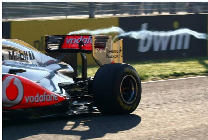
**Figura II.19.-** Alerón trasero poco eficiente generando vórtices en sus puntas
