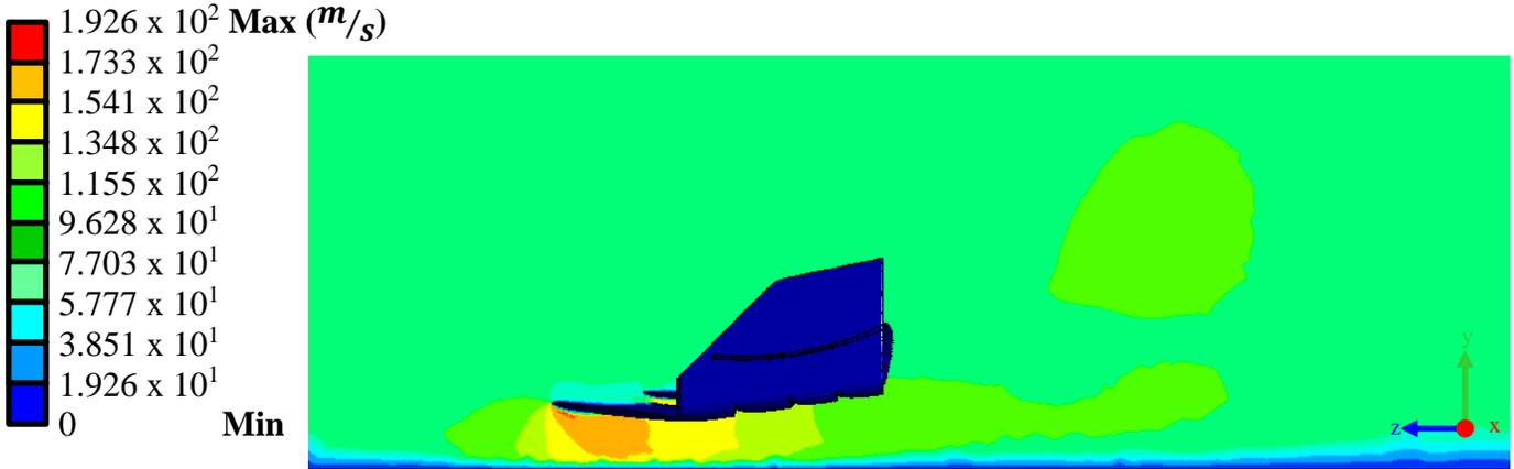
**Figura IV.21.-** Velocidad del viento sobre alerón *MICC-75* a 250 mm del plano medio del alerón
