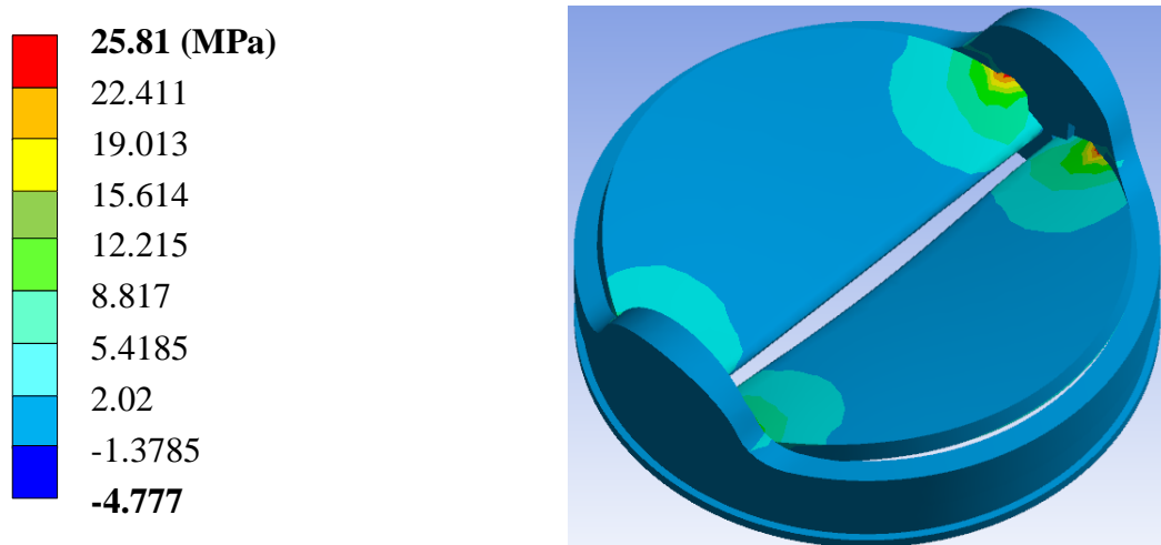
Figura IV.45.- Segundo caso de estudio; Esfuerzo principal máximo
