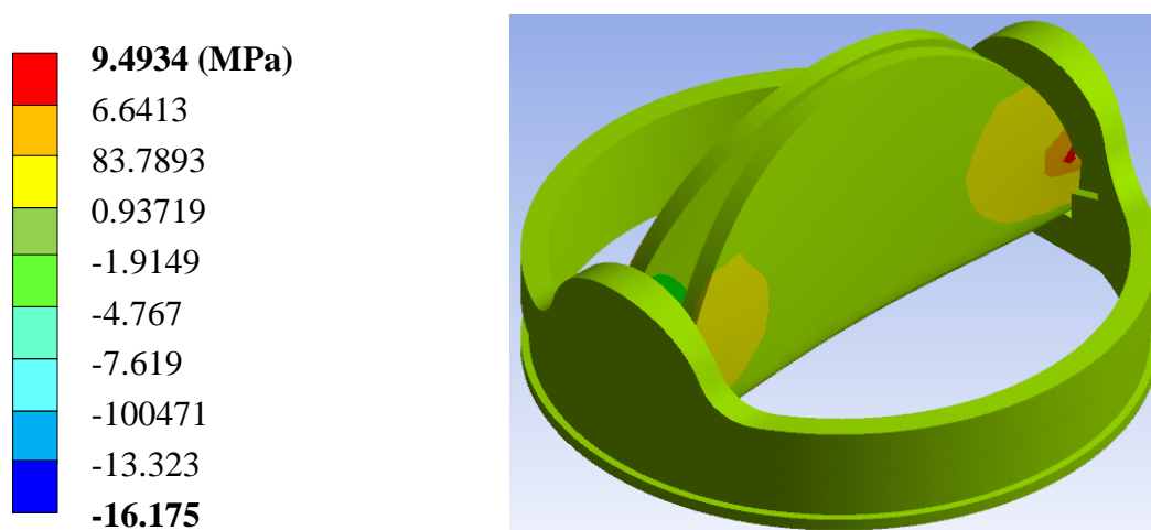
Figura IV.57.- Tercer caso de estudio; Esfuerzo nominal en el eje Y
