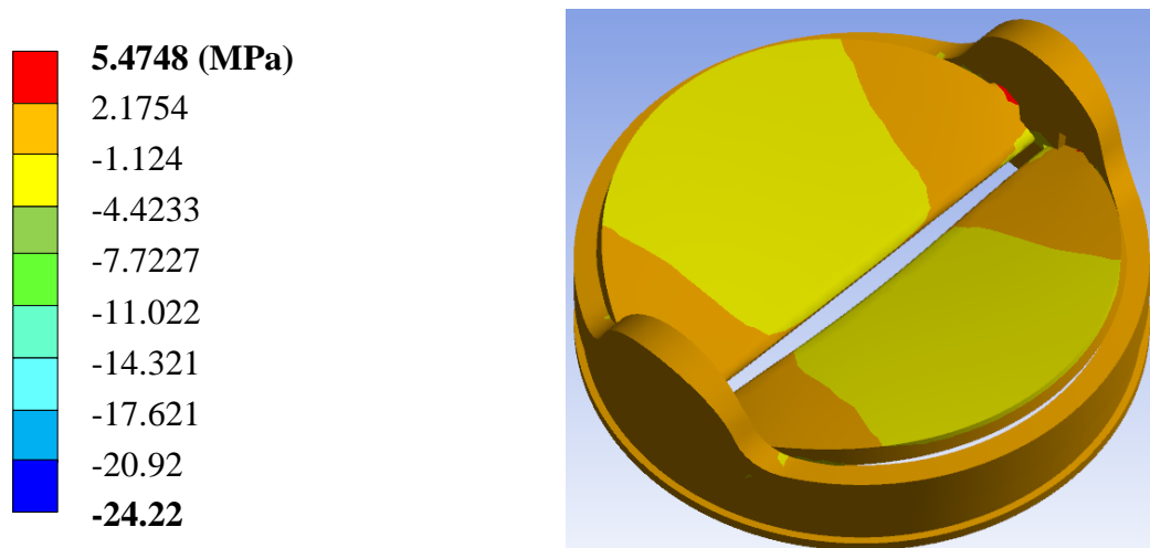
Figura IV.46.- Segundo caso de estudio; Esfuerzo principal mínimo
