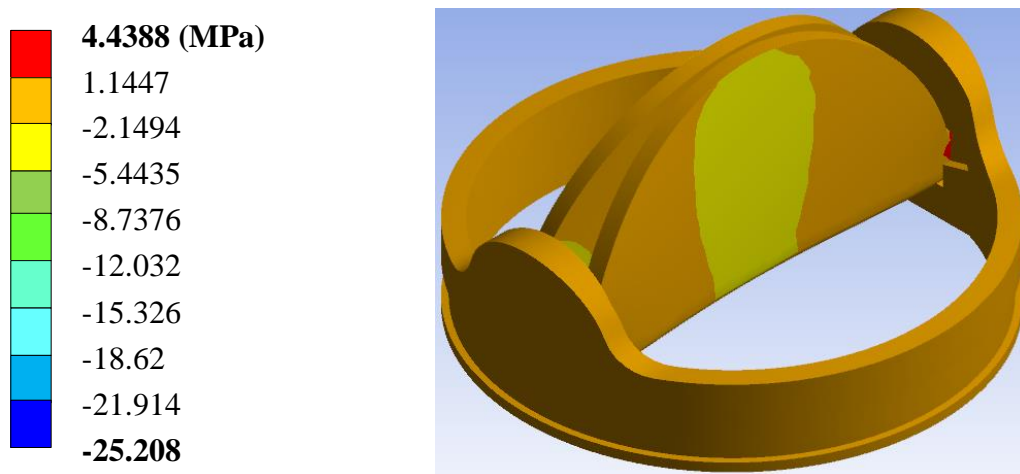
Figura IV.64.- Tercer caso de estudio; Esfuerzo principal mínimo
