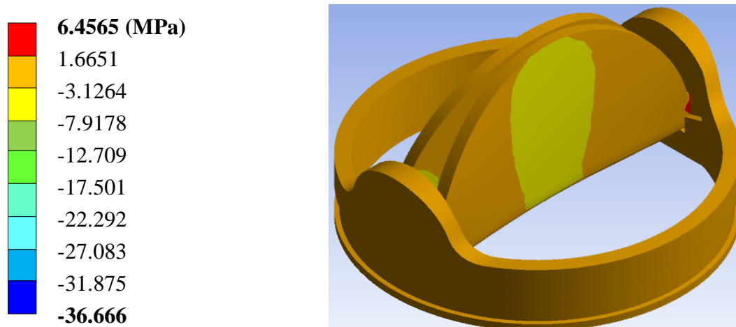
Figura IV.82.- Cuarto caso de estudio; Esfuerzo principal mínimo
