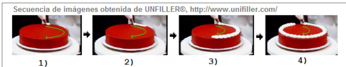
Figura 1.7. Secuencia de imágenes de un pastel decorado por medio de rotación y depositado semiautomático.
