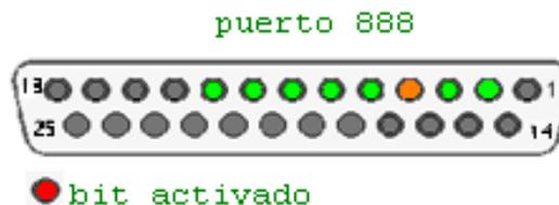
Figura 6.2.3. Puerto de salida y activación de 1 bit.
