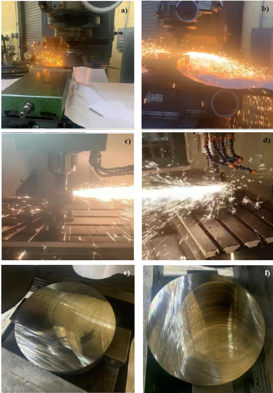
Fig. 34 Generación de texturas adaptando la piedra de esmeril a) y b) a una fresadora convencional, c) y d) a una fresadora CNC, e) y f) texturas generadas después de esmerilado.
