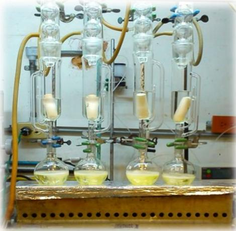
**Figura 3.- Equipo de Soxhlet utilizado para la extracción del aceite de la harina de soya.**
