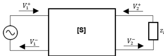
Figura 2.9. Red de dos puertos de entrada, sistema "Scattering".
