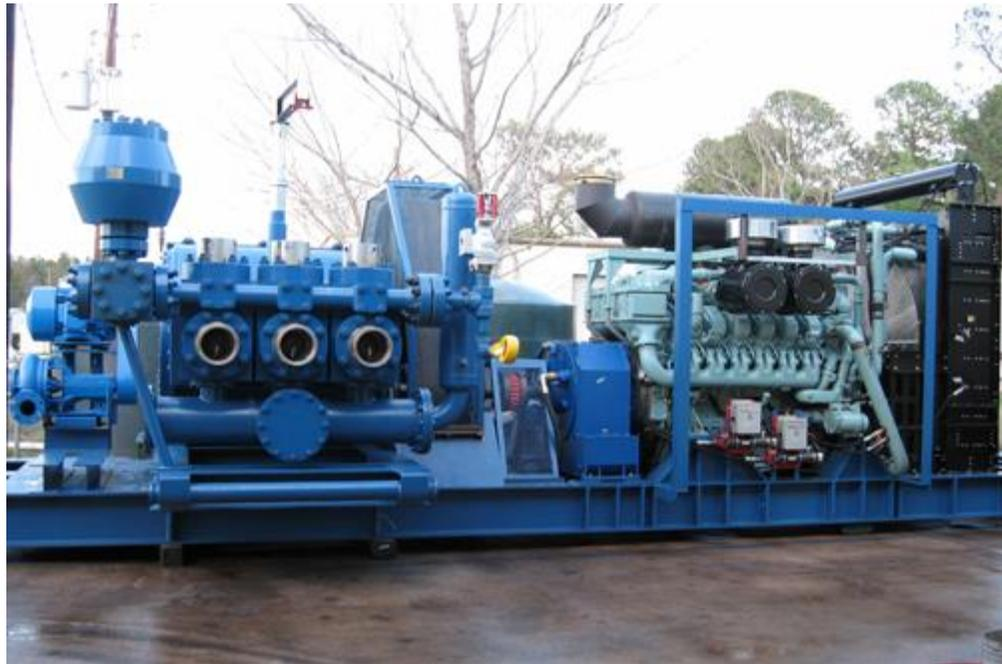
*Figura 3.11.- Vista lateral de una Bomba Tríplex.*
