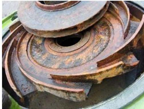
*Figura 3.16.- Ejemplo de desgaste por corrosión.*
