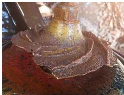
*Figura 3.17.- Ejemplo de desgaste por abrasión.*
