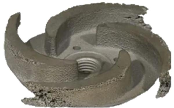
*Figura 3.15.- Ejemplo de desgaste por erosión.*
