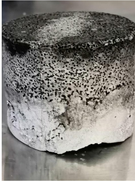
Figura 36. Prueba No.4 de infiltración en esponja de Zinalco.
