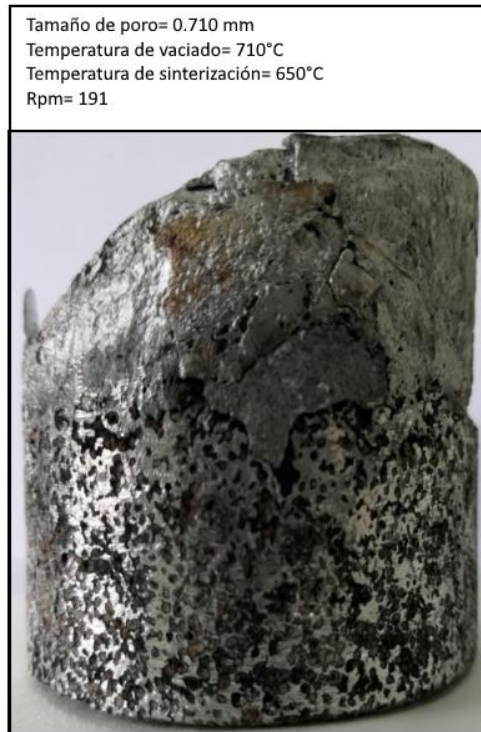
Figura 40. Espuma metálica de aleación con tamaño de poro de 0.710 mm.
