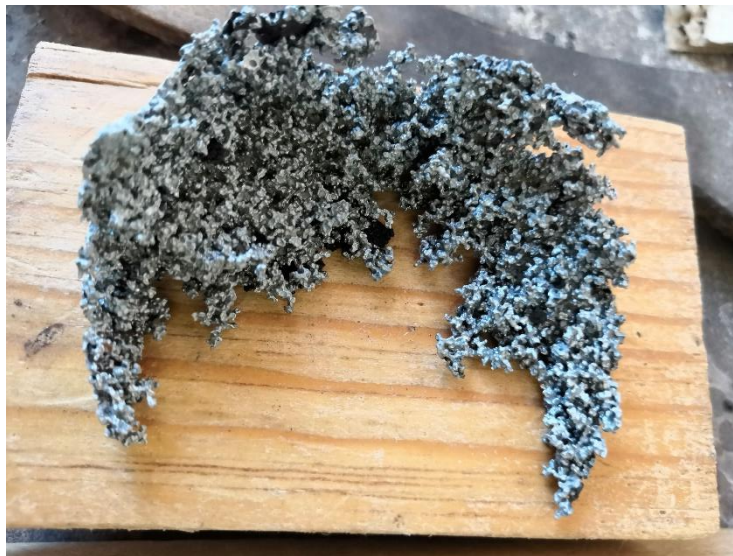
Figura 34. Prueba No.2 de infiltración en esponja de Zinalco.
