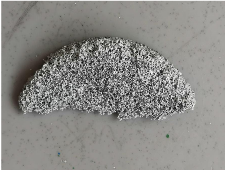
Figura 33. Prueba No.1 de infiltración en esponja de Zinalco.
