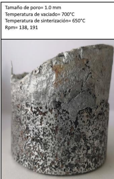
Figura 37. Espuma metálica de aleación con tamaño de poro de 1.0 mm.
