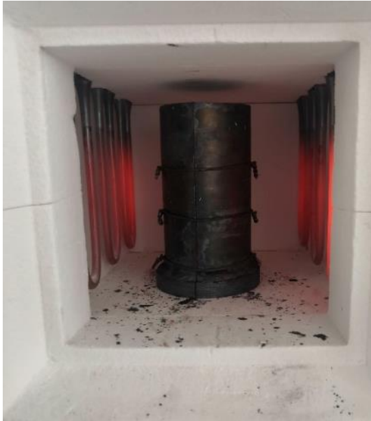
Figura 30. Introducción del molde de la espuma en la mufla.
