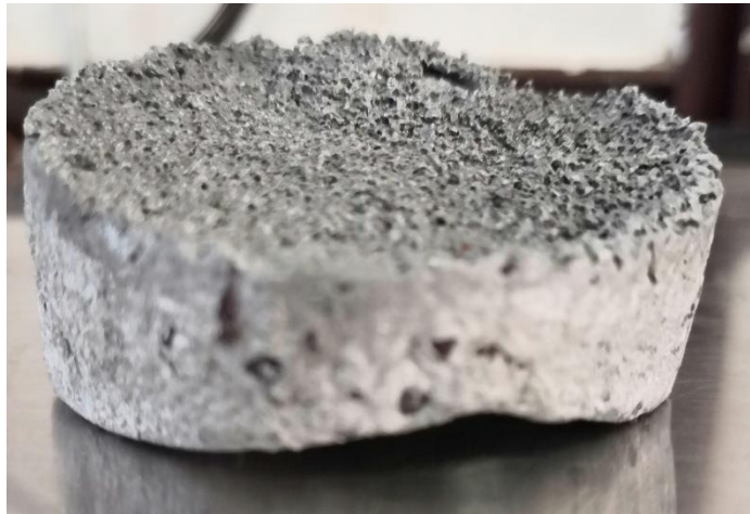
Figura 35. Prueba No.3 de infiltración en esponja de Zinalco.
