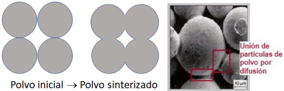
Figura 18. Proceso de sinterización y unión de polvos compactos [36].
