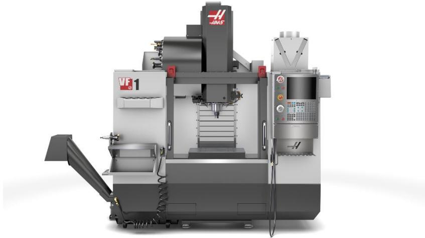
Nota. Imagen de la fresadora CNC VF-1 marca HASS usado por Nutriequipos S.A. de C.V.
