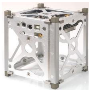
Ilustración 11. Subsistema estructural de un CubeSat.
