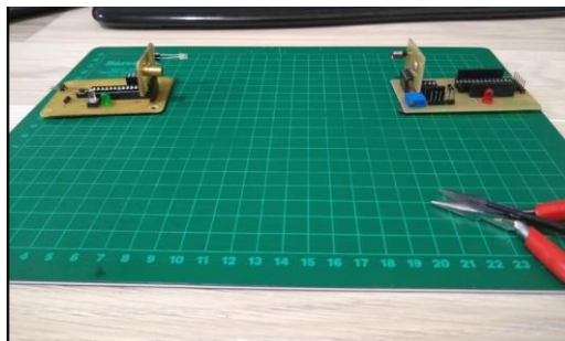
Ilustración 30. PCB's prototipo versión 2.0 y pruebas del enlace alcanzado.
