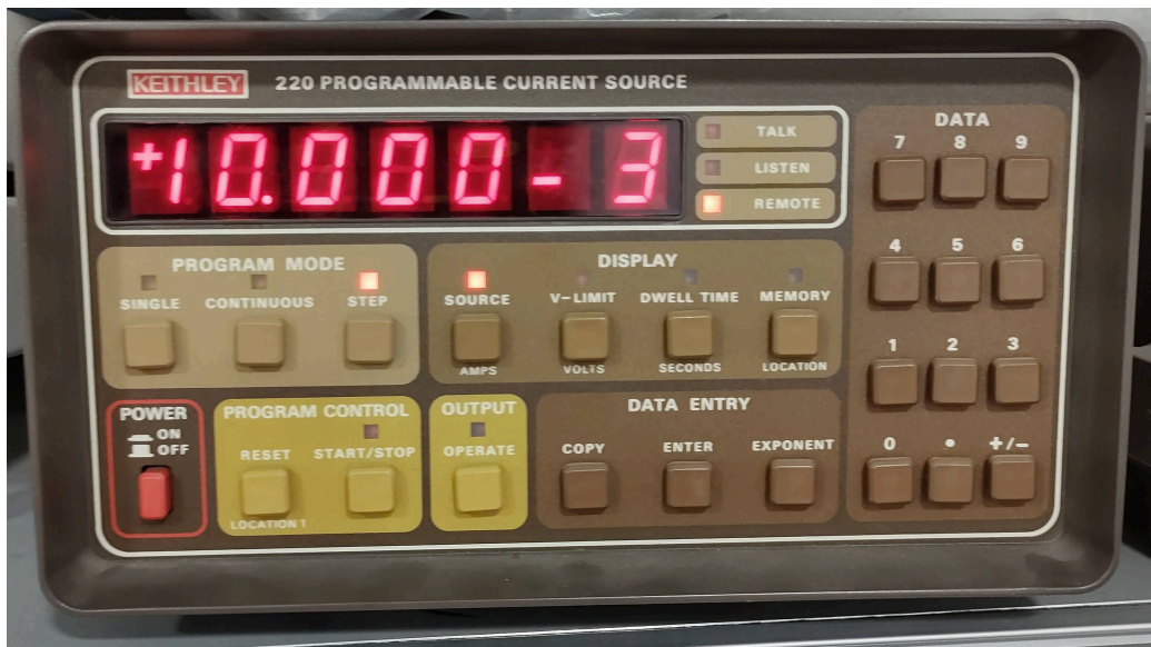
Figura 3.10: Fuente de Corriente Keithley modelo 220 marca tektronix, proveedor de la corriente en la muestra.
