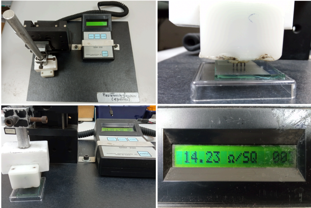
Figura 5.4: Sistema de medición de cuatro puntas para calcular la resistividad
