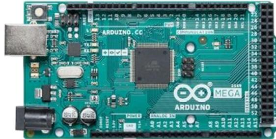
Fig. 10 Arduino Mega
