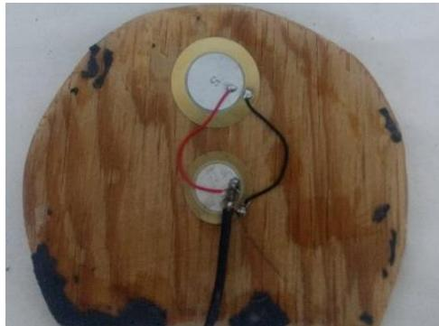
Fig. 18 Arreglo en paralelo de piezoeléctricos
