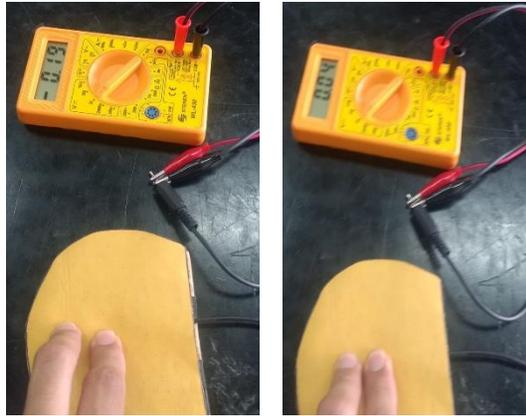
Fig. 57 Medición con multímetro y vinil estampado.
