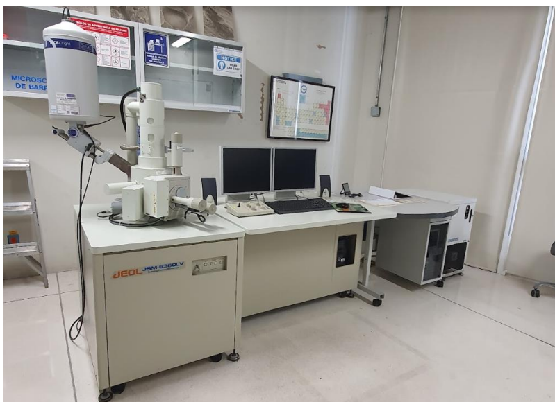
Figura 2.19 Equipo JOEL JSM-6360LV. Cortesía Grupo de Investigación de Tecnología de Plásticos del ITESM CEM.
