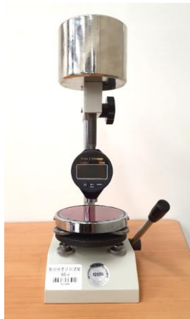
Figura 2.16 Durómetro Shore SI-TV. Cortesía Grupo de Investigación de Tecnología de Plásticos del ITESM CEM.
