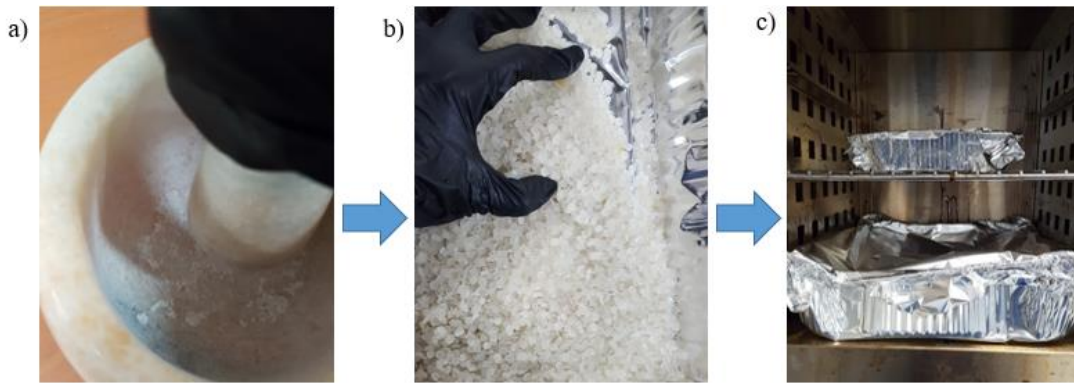
Figura 2.3 Preparación de la mezcla r-PVB-MA: a) molido del MA, b) mezcla manual del r-PVB y el MA, c) secado del r-PVB y el MA.
