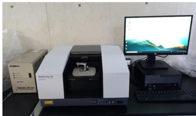
Figura 2.10 Equipo Shimadzu IRAffinity-1S. Cortesía Grupo de Investigación de Tecnología de Plásticos del ITESM CEM.
