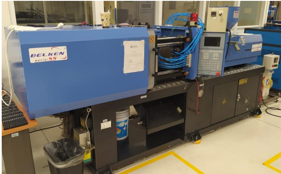
Figura 2.5 Máquina inyectora Belken SSF500-k5. Cortesía Grupo de Investigación de Tecnología de Plásticos del ITESM CEM.
