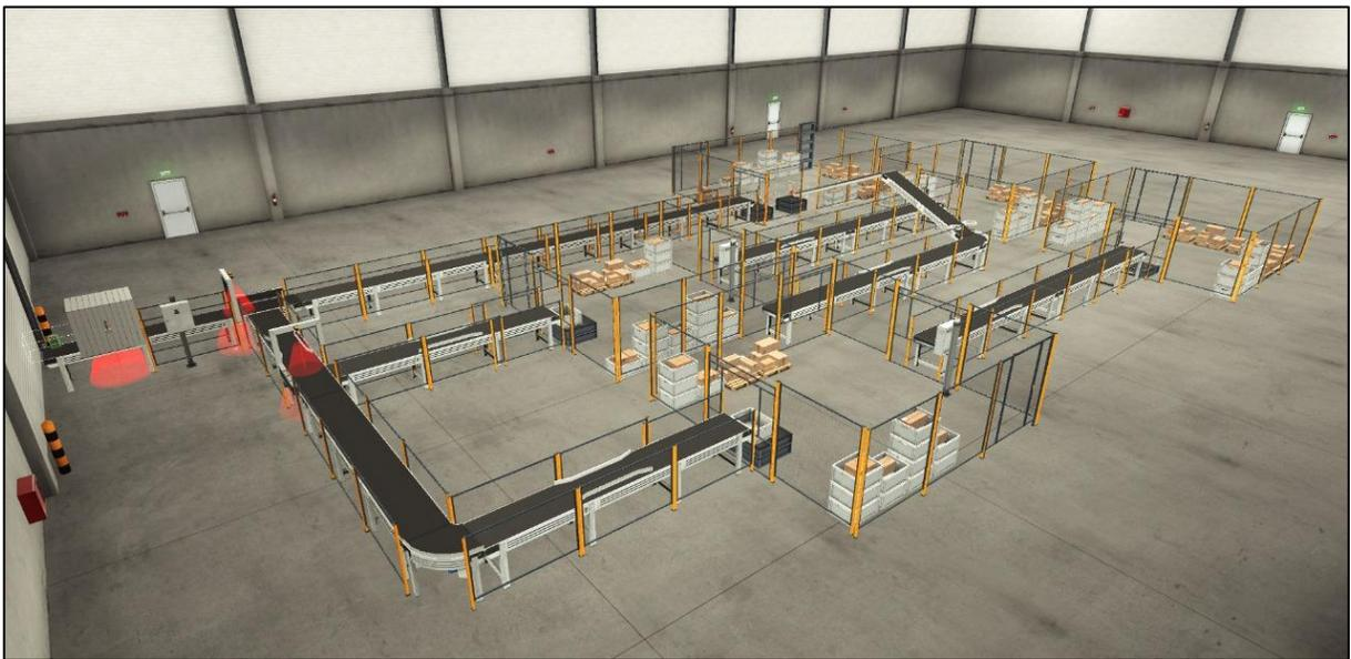
*Figura 3.37 [Vista general del Sistema en Factory I/O].*
