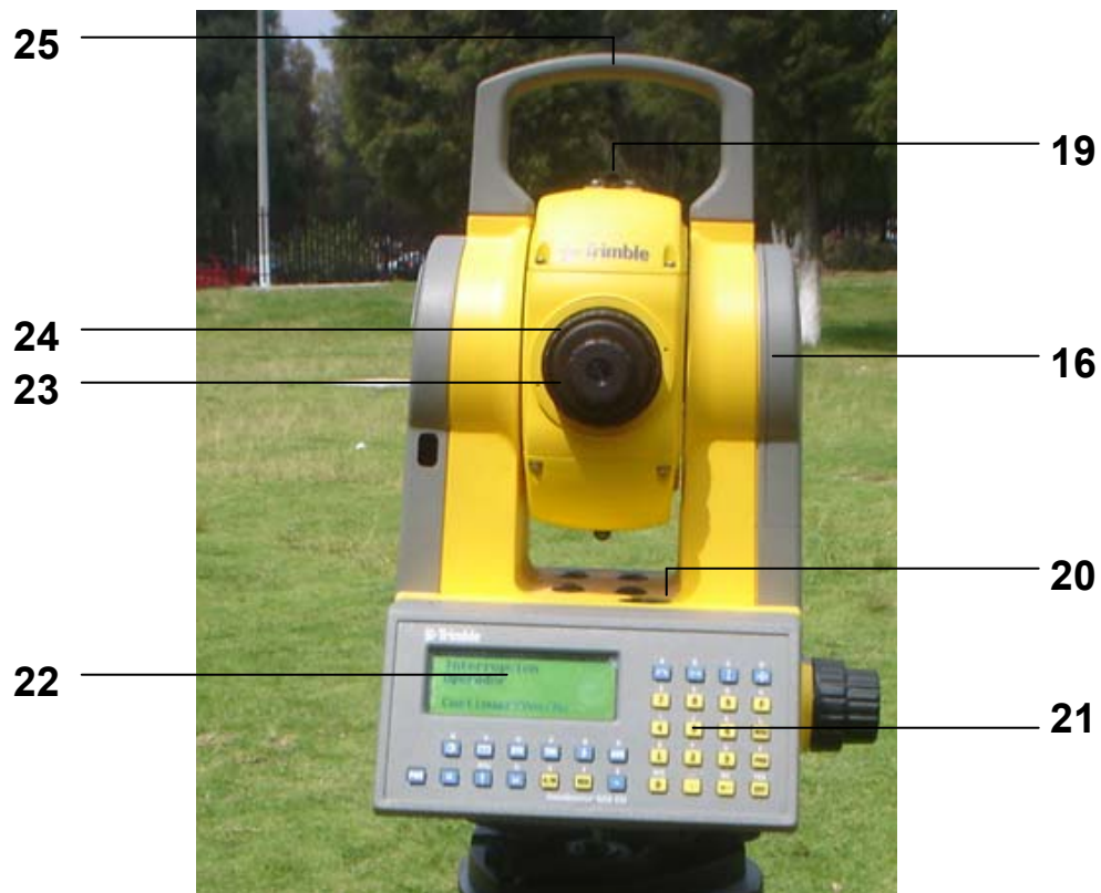
Fig. 05.- Cara posterior de una estación total marca Trimble ZE-3600.
