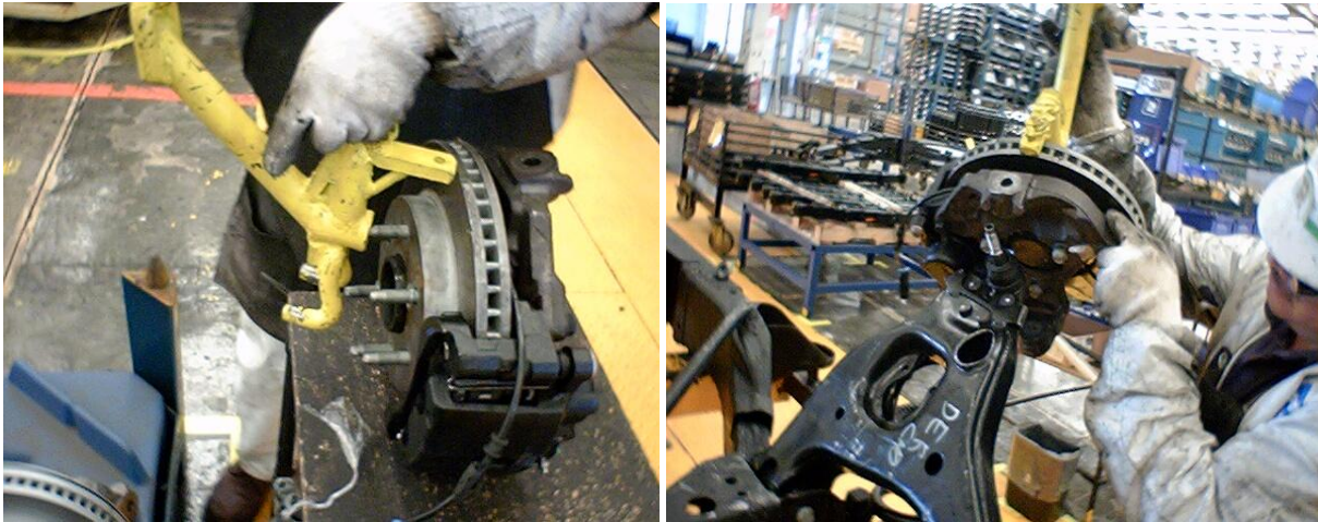
Fig. 17 Estos ganchos fueron comunizados entre la nueva camioneta y los vehículos de la línea
