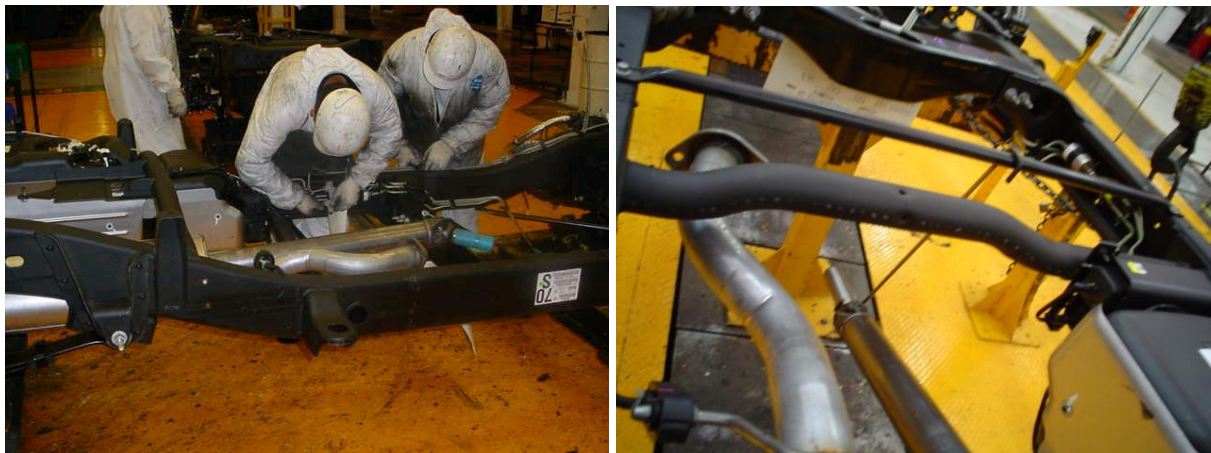
Fig. 21 Se requirió relocalizar la tubería de frenos para instalarlo en otra estación y evitar el problema de carácter ergonómico.
