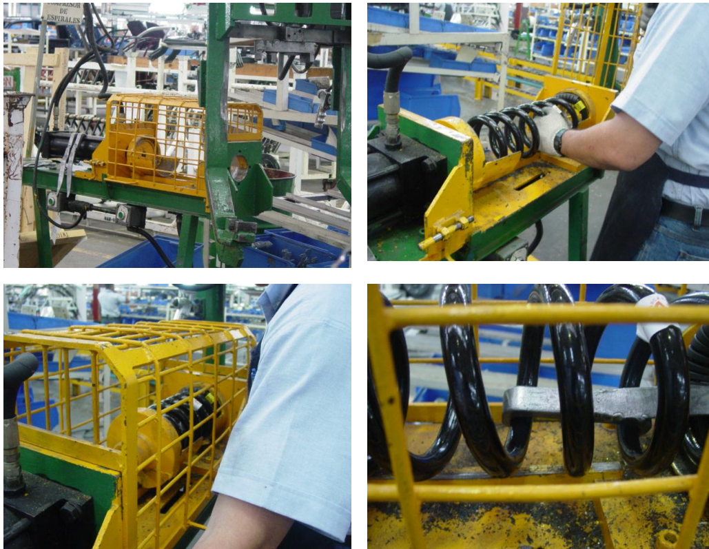
Fig. 13 Procedimiento usado en GM Venezuela para la precompresión de resortes
