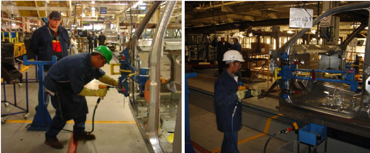
Fig. 56 Disminuir 25 cm la altura de la plataforma eliminó por completo el problema ergonómico, pero ocasiono un problema con el personal de mantenimiento.
