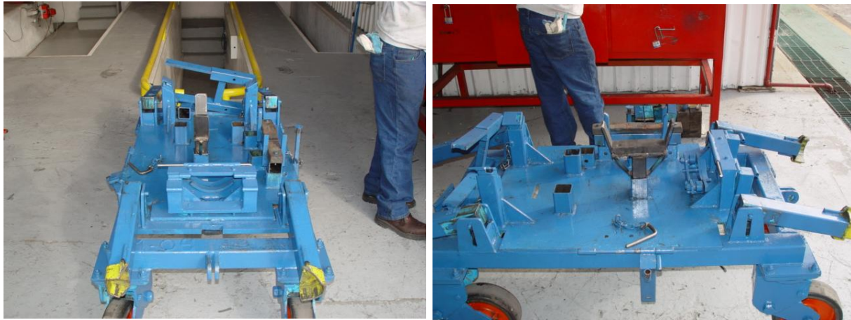
Fig.31 Fue necesario modificar la soportería del carrito para soportar el nuevo motor.
