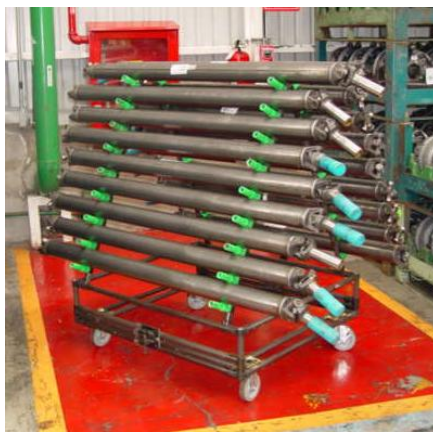
Fig. 27 Dollies diseñado para el surtido de flechas cardan al punto de uso.
