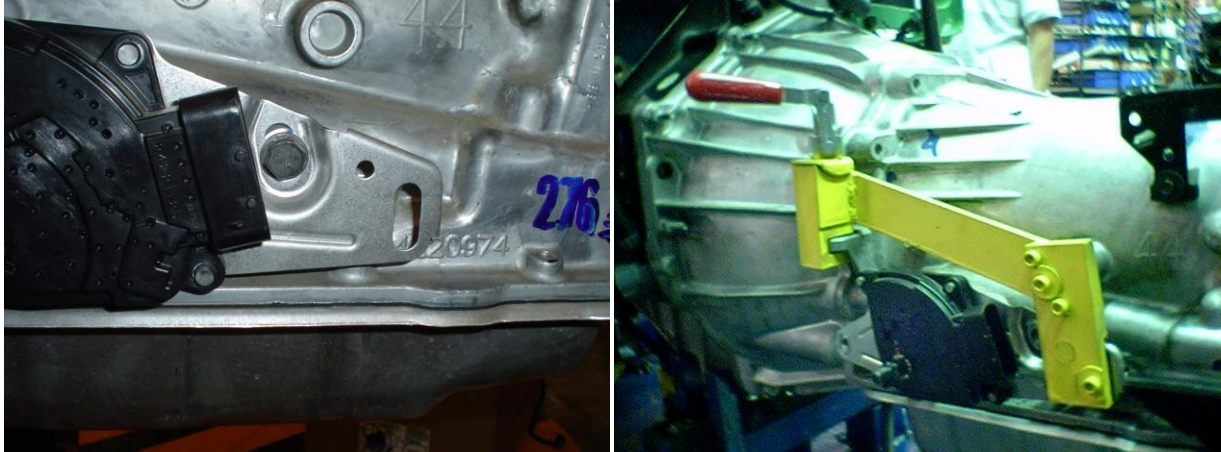
Fig. 38 Dispositivo para posicionar el switch de la transmisión.
