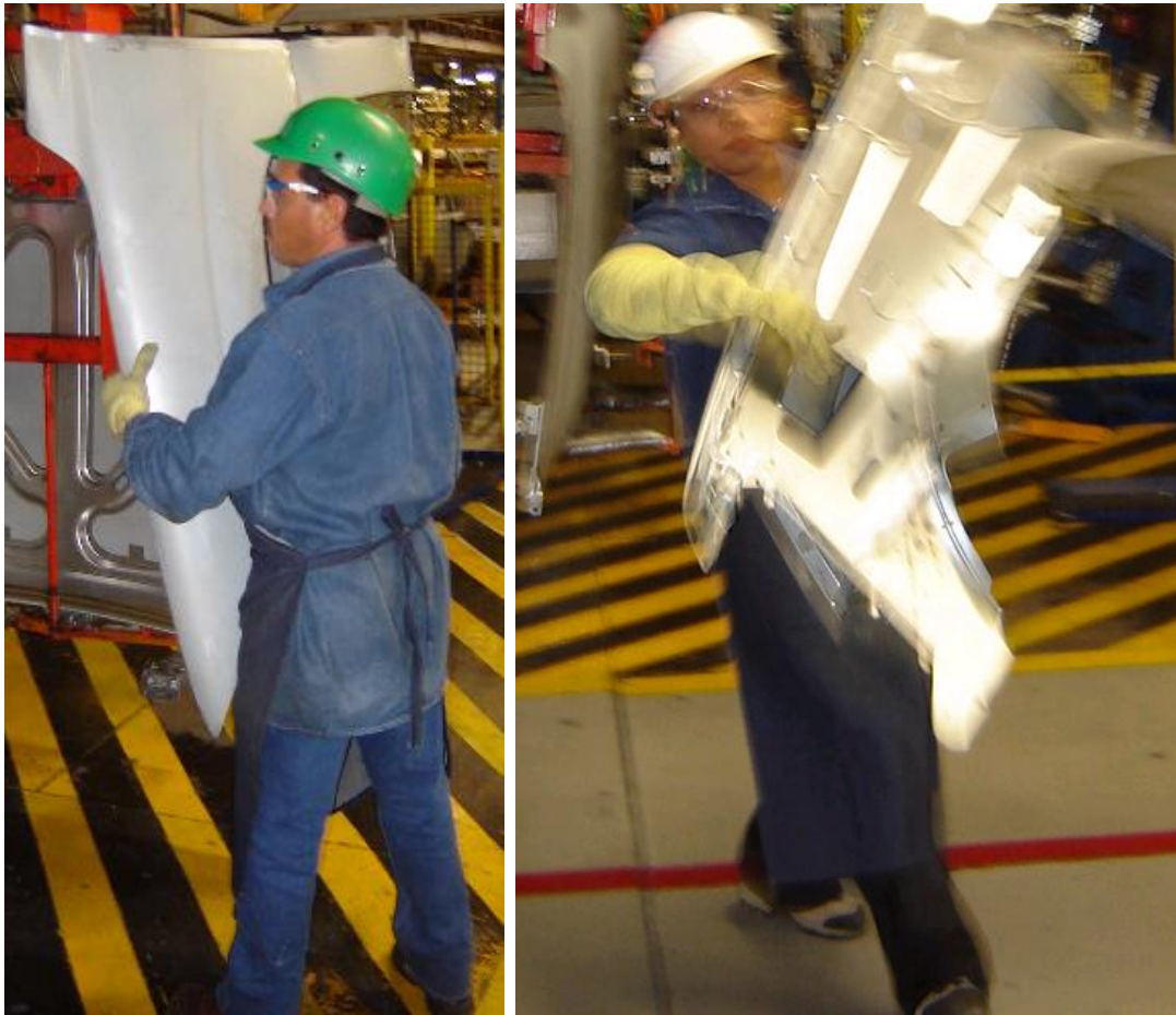
Fig. 57 Esta operación en los modelos GMT-800 era realizada por 2 operadores de forma completamente manual, para el modelo GMT-900 se requirió el uso de manipuladores.
