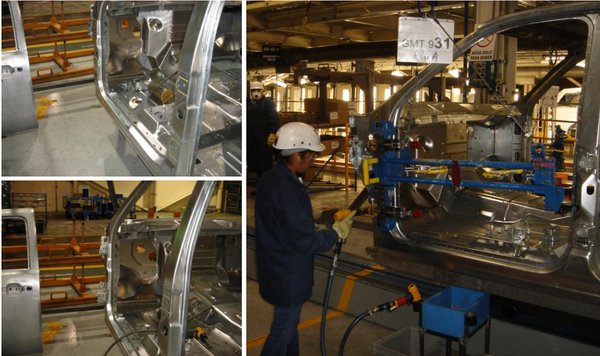
Fig. 44 La instalación de bisagras en la plataforma GMT-900 se realizaría mediante tornillos colocados en los pilares del marco de las puertas a diferencia del GMT-800 que están eran soldadas.
