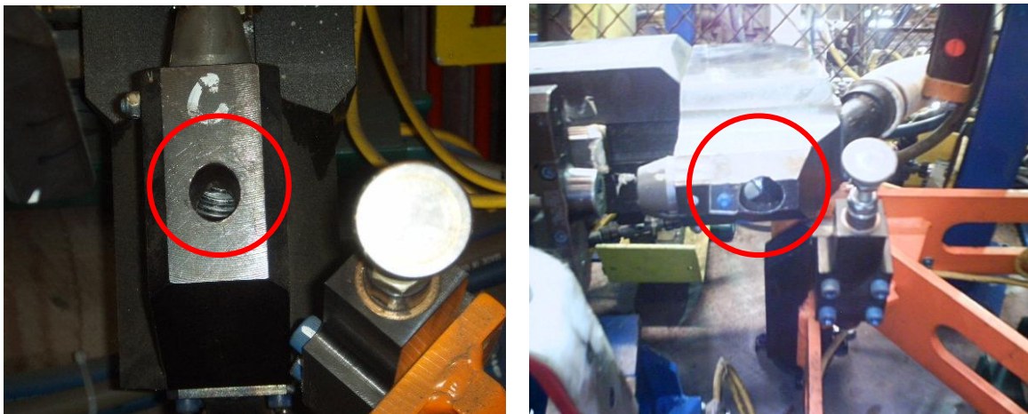
Fig. 49 Fichas acumuladas dentro de las mangueras de las unidades de troquelado.
