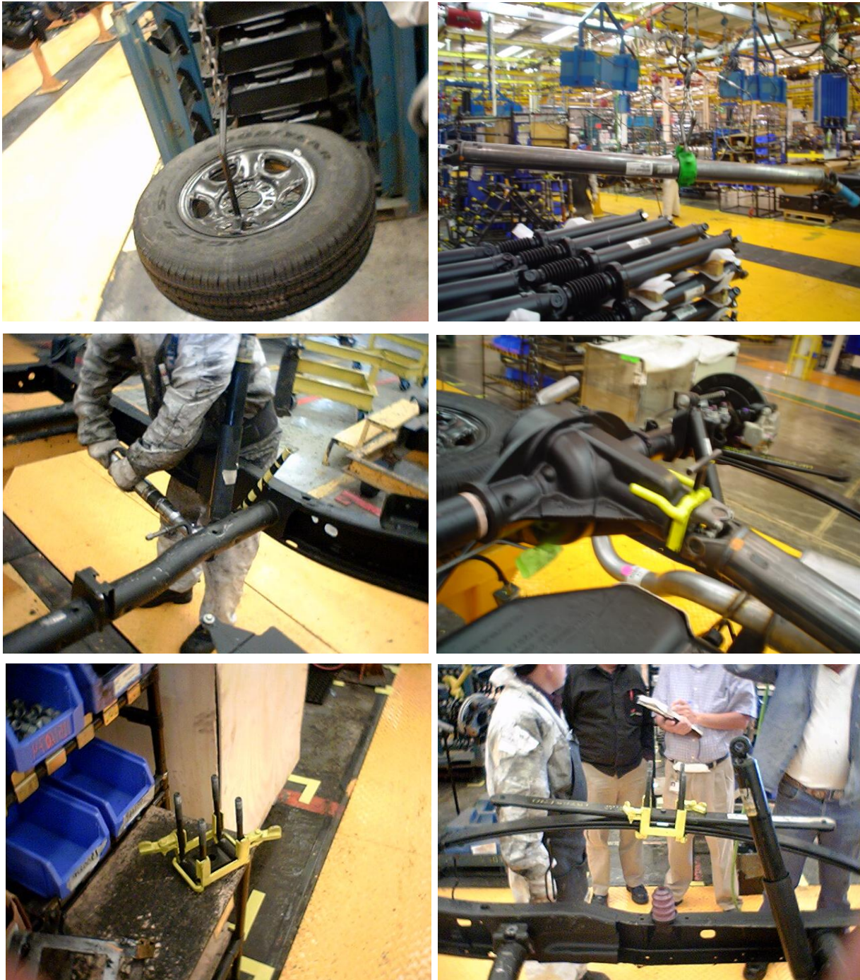
Fig. 19 Ganchos para soportar partes, contras y dispositivos de sujeción de tornillos "U".
