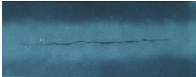
Radiografía de una fractura longitudinal
