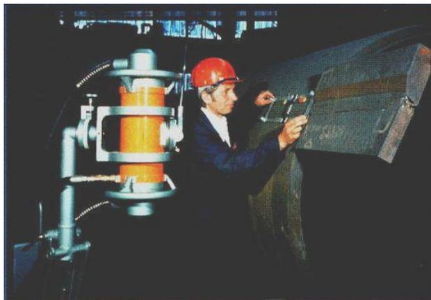
Inspección de la soldadura de un recipiente a presión
