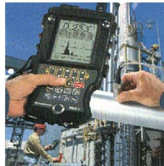
Equipos de inspección por ultrasonido por contacto
