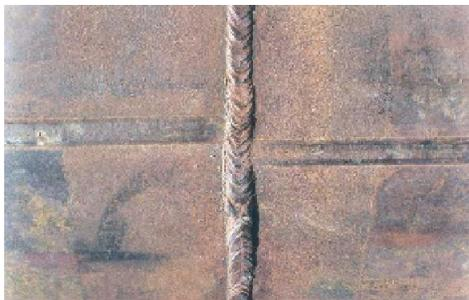
Ejemplo de una unión soldada incorrecta
