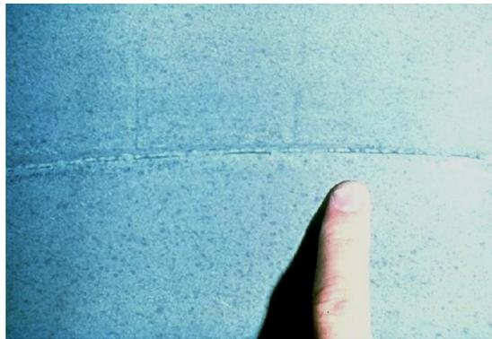
Vista interna de una falta de penetración
