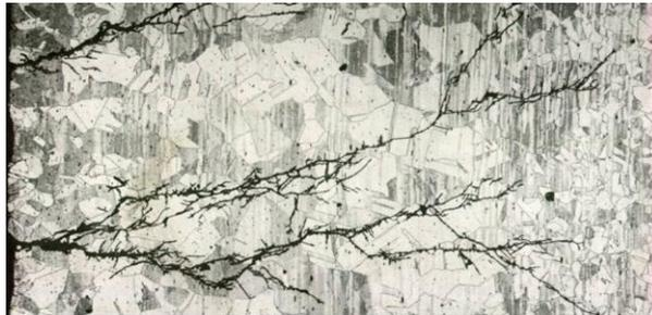
Micrografía de una fractura en acero austenítico
