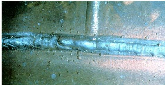
**Chisporroteo en una unión soldada**
