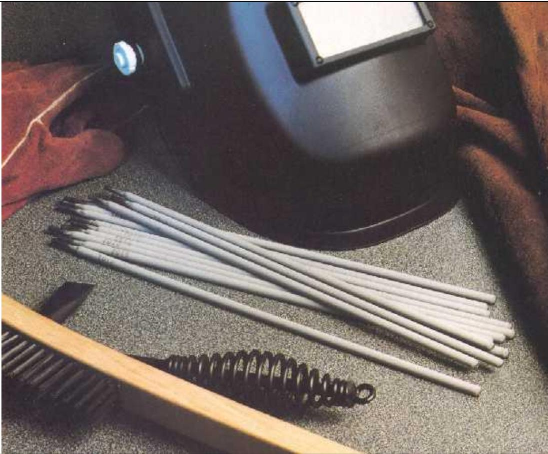
**equipo básico empleado en la soldadura de electrodo recubierto**
