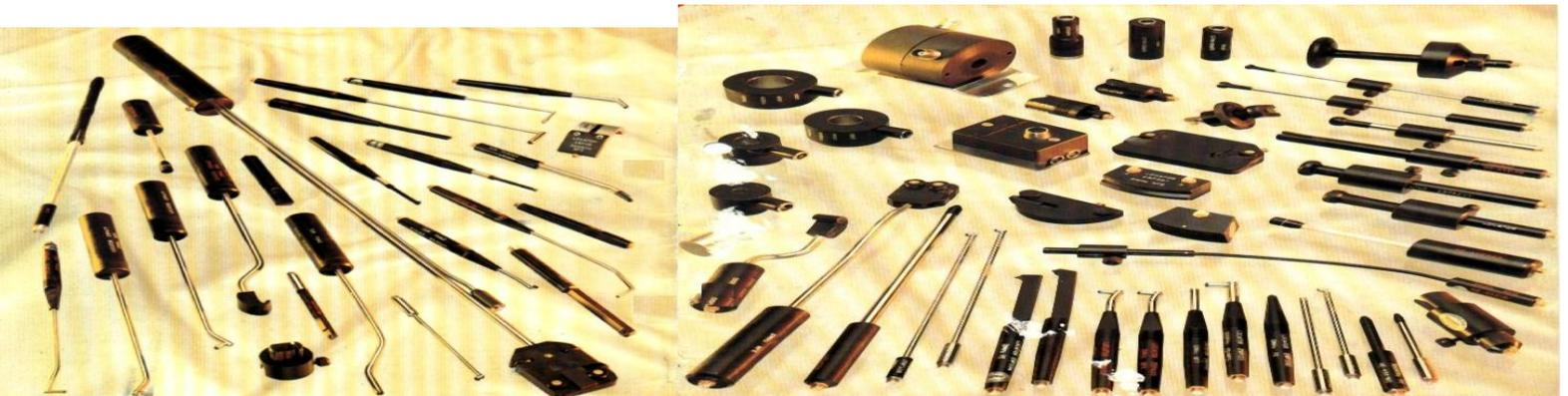
Ejemplo de algunas de las sondas empleadas en la inspección por electromagnetismo
