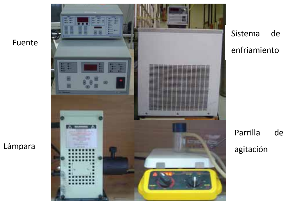
Figura 2.2: Equipo experimental para la evaluación catalítica.
