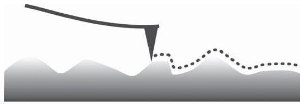
Figura 2.12 – Barrido en modo de contacto de un microscopio de fuerza atómica.
