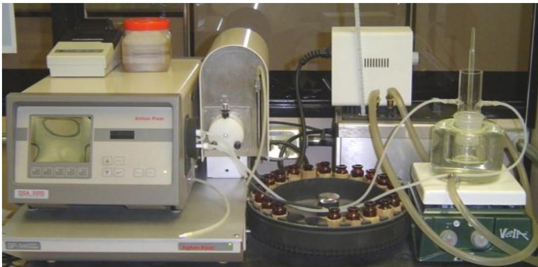
Figura 2.5 – Analizador de densidad y sonido Anton Paar DSA5000.
