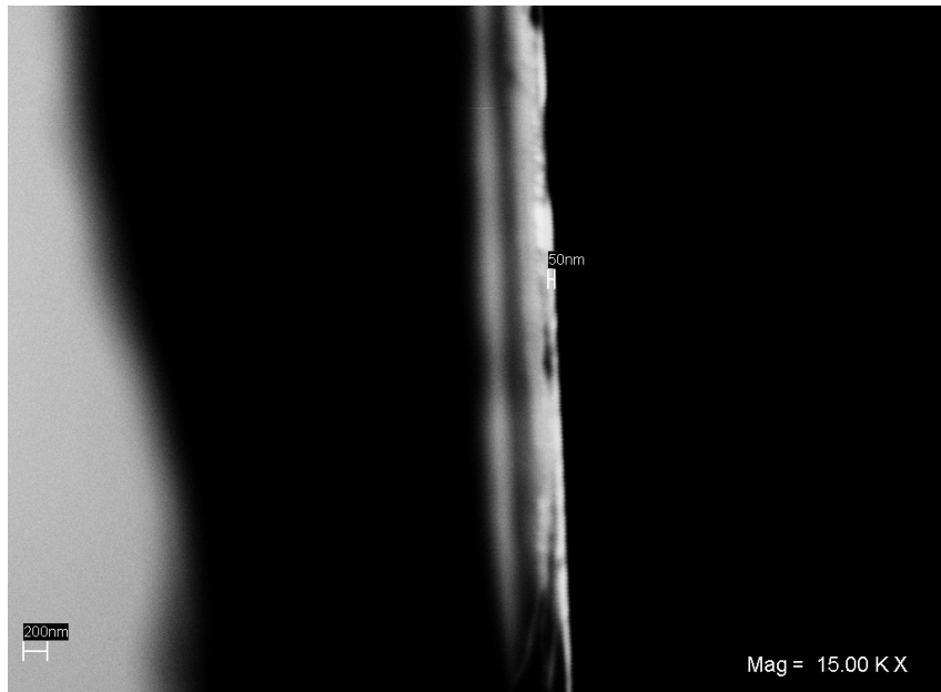
Fig. 4.9 Imagen transversal de MEB de una muestra depositada a 450^{\circ}\text{C} con tres pulsos
