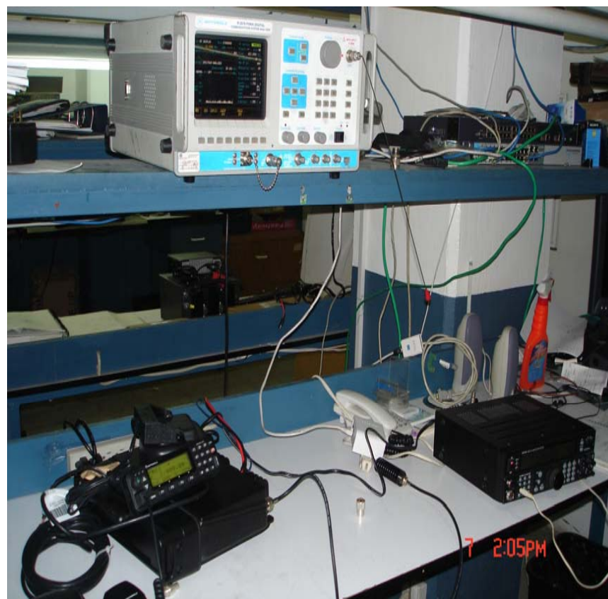
Fig. C-4 Panorama general de la medición de SINAD.
