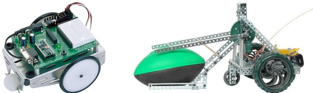
Figura 2.14. Robots móviles con configuración diferencial.
