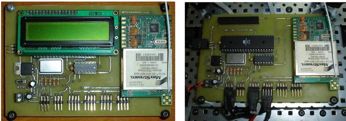
Figura 3.16. Circuito impreso del módulo de control.
