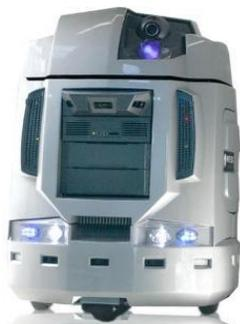
Figura 2.12. Robot con conducción síncrona.
