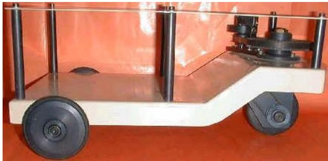
Figura 2.10. Robot móvil con configuración de triciclo.
