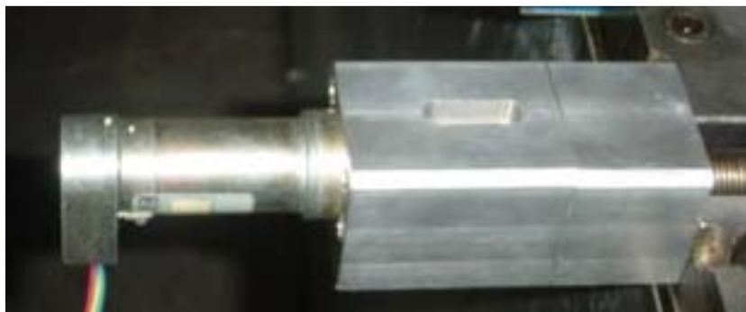
Figura 3.13 Montaje del motor a la mesa.
