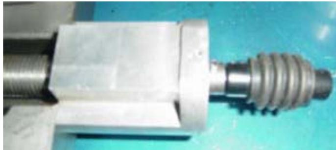
Figura 3.12 Nudo para acoplamiento del motor con la flecha del motor.
