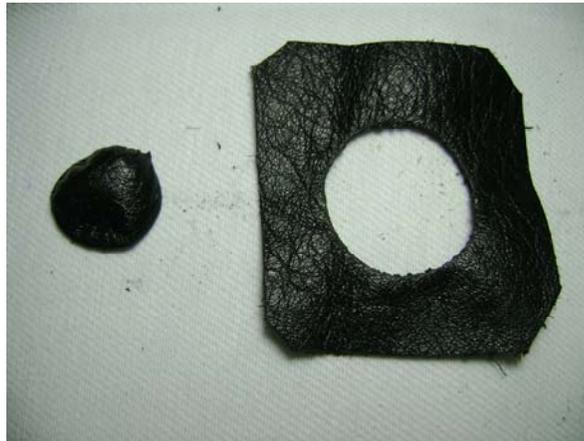
Figura 4.6 Corte sobre piel de ganado vacuno de 1mm de espesor.
