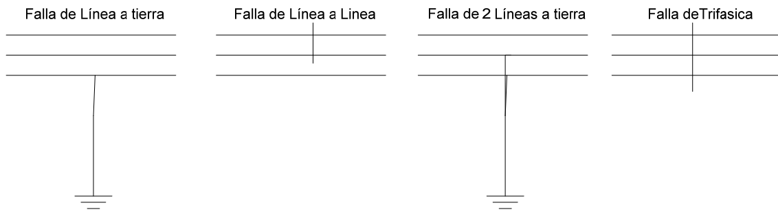
Figura 2.1 Tipos de fallas en sistemas eléctricos
