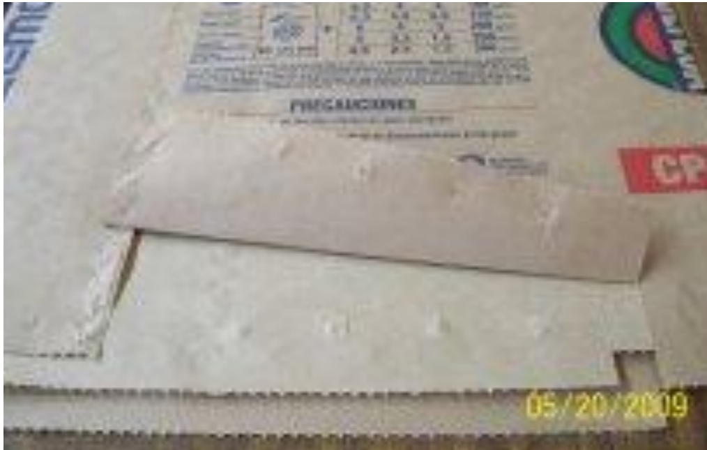
Figura 49 – Puntos de pegamento por Encoladores Transversales
