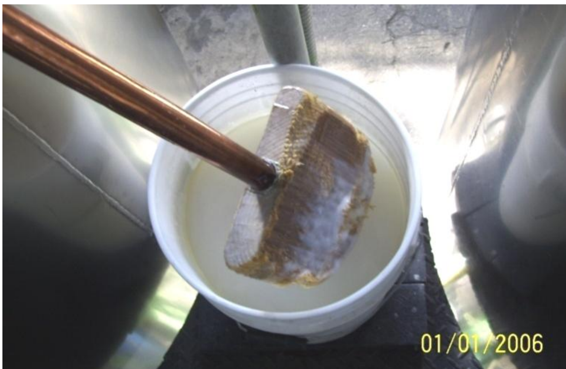
Figura 27 – Espátula para remover fondo y paredes de la mezcladora
