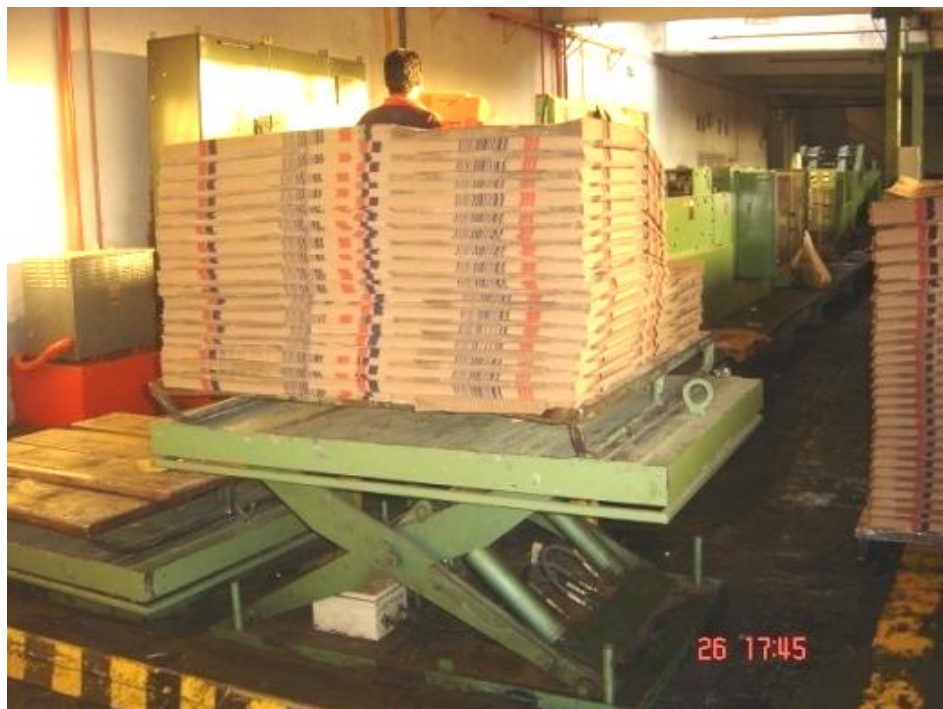
Figura 61 – Inicio de proceso alimentación de tubos
