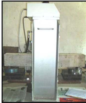
a) Montaje de la viga en la prensa
