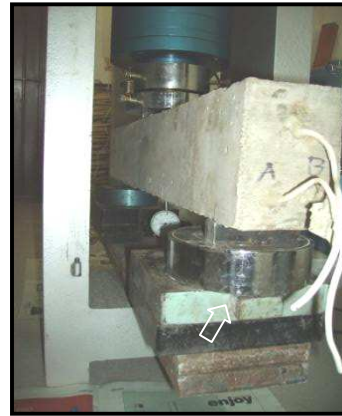
b) Detalle del apoyo de la viga
