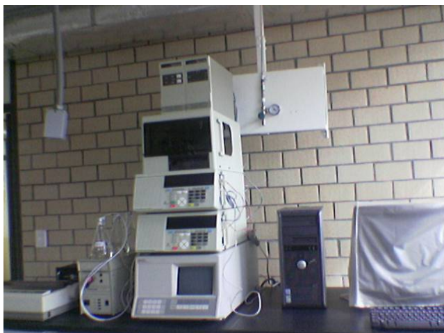
Figura 8. Cromatógrafo de líquidos de alta resolución utilizado para la detección y cuantificación de la hormona en muestras de alimento y agua.
