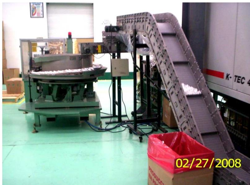
Fotografía 3.2. Banda transportadora y tina vibradora
