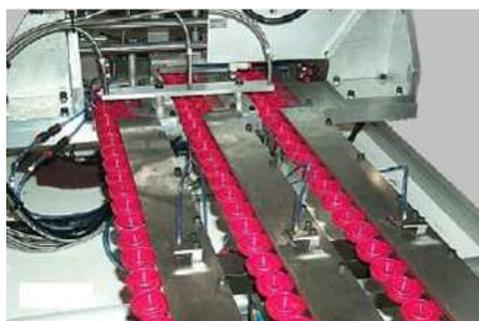
Fotografía 1.3. de una máquina cerradora tipo Flip - Top
