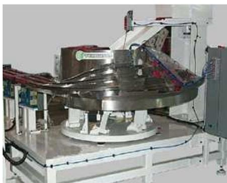
Fotografía 1.4. de una tina vibradora
