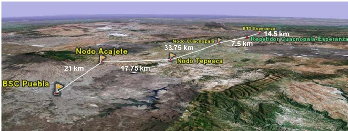
Figura 4.1 Enlace principal de la red de microondas.
