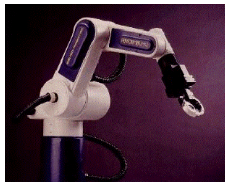
Figura 1.5: Esquema de un robot de configuración angular
