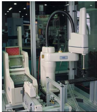
Figura 2.3: Brazo manipulador tipo SCARA industrial
