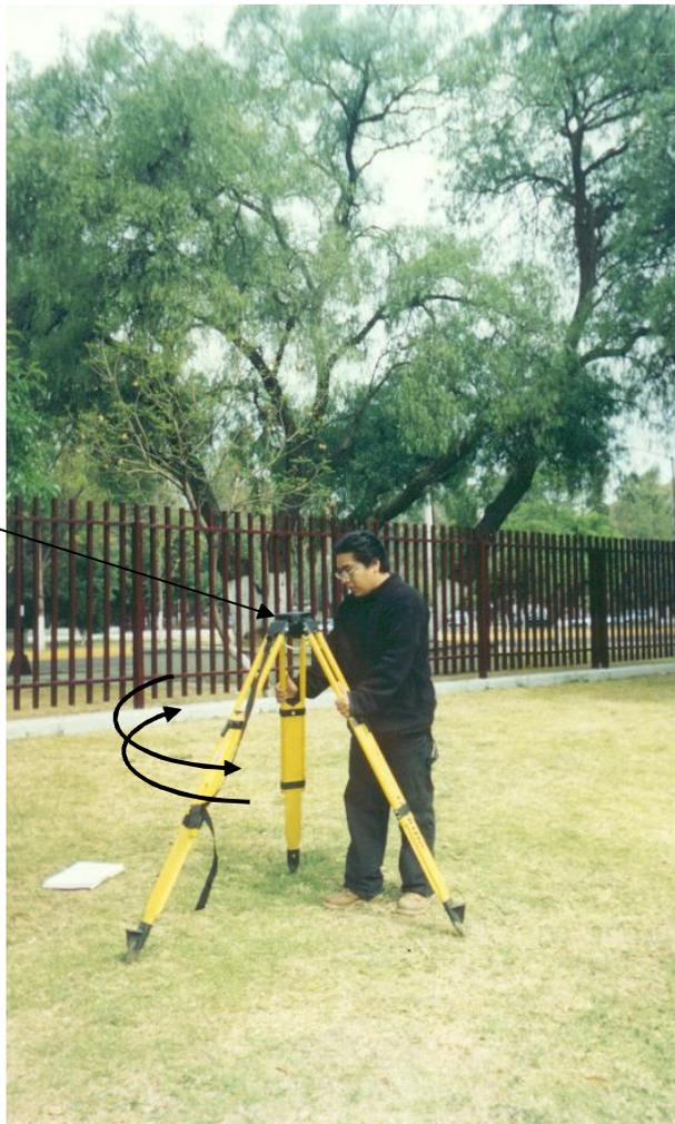
6. Al observar que el tripié esta aproximadamente ubicado sobre el vértice se monta la estación total y se observa por la mirilla de la plomada óptica que la retícula de dicha plomada esté lo más cerca al vértice.
