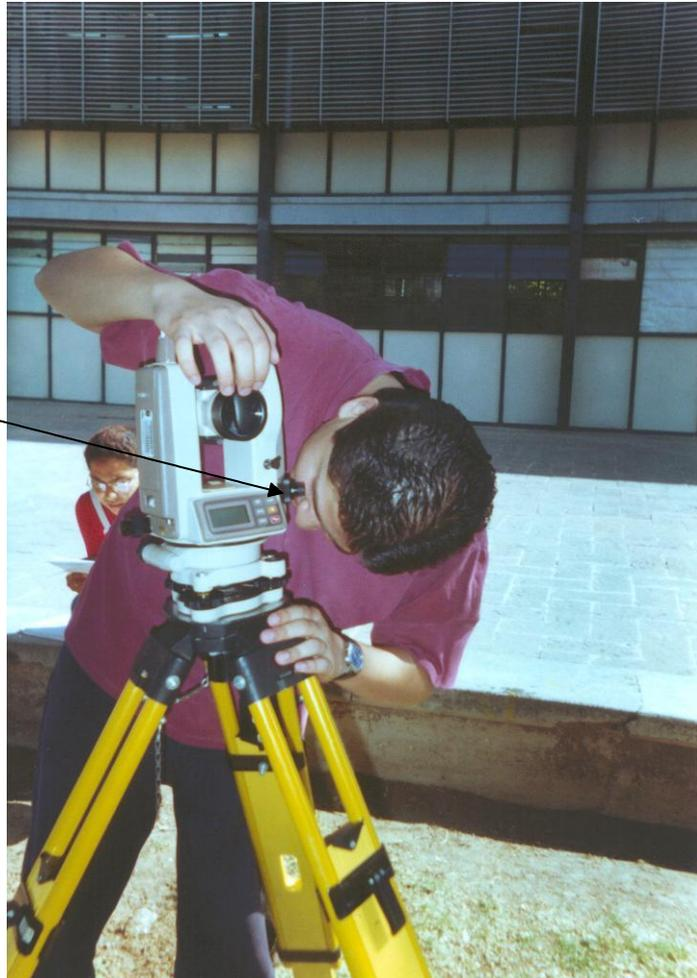
7. Al constatar que la visual de la plomada óptica esté cerca del vértice se procede al encajar las patas del tripié para evitar que éstas se muevan y provoquen un error al realizar el levantamiento.
