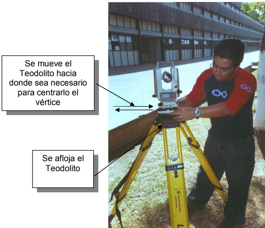
18. Si después de las nivelaciones de las burbujas de aproximación y de precisión la retícula de la plomada óptica se encuentra al centro del vértice, el aparato se encuentra centrado y nivelado sobre el vértice.
