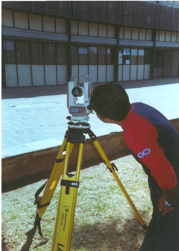
17. Si la retícula de la plomada se encuentra desplazada del centro del vértice lo que se hace es aflojar el teodolito electrónico del tripié y se mueve dicho teodolito hasta lograr que la retícula se encuentre nuevamente al centro del vértice, al lograr esto se aprieta nuevamente el tornillo que sujeta el teodolito al tripié.
