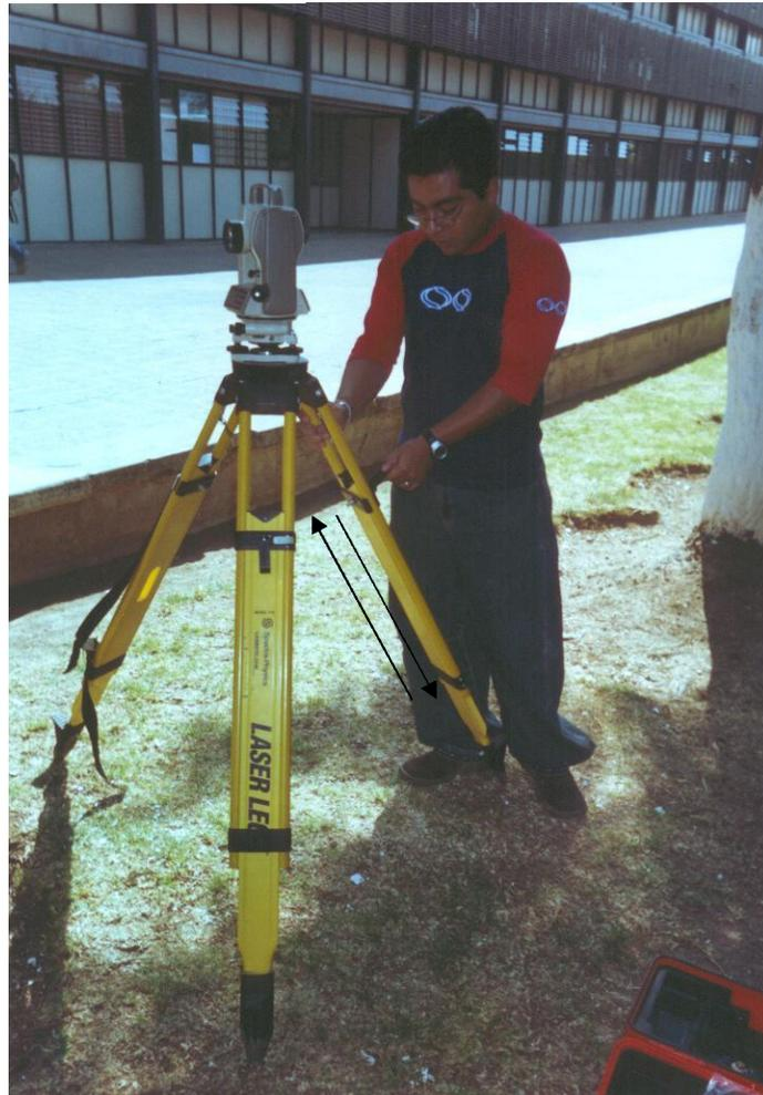
13. Esta operación se realiza las veces que sean necesarias hasta lograr que la burbuja se sitúe dentro de un círculo marcado sobre el cristal que protege a la burbuja.
