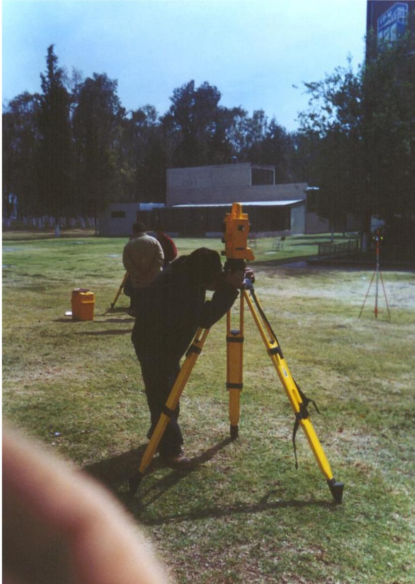
25. Pero si la retícula de la plomada óptica se encuentra desplazada del centro del vértice lo que se hace es aflojar la estación total del tripié y se mueve dicha estación hasta lograr que la retícula se encuentre nuevamente al centro del vértice, al lograr esto se aprieta nuevamente el tornillo que sujeta la estación al tripié
