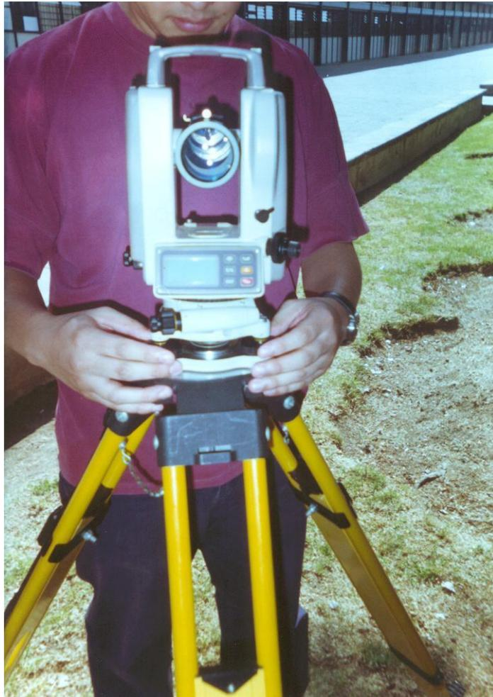
9. Se observa por la mirilla de la plomada óptica y se giran los tornillos niveladores en la dirección que sea necesaria hasta lograr que la retícula de la plomada esté en el centro del vértice, logrando así centrar el teodolito sobre el vértice de la poligonal.
