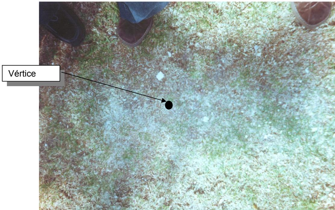
2. Se centra el tripié abriendo las patas del tripié posicionándolo sobre el vértice de la poligonal en donde se iniciará el levantamiento.
