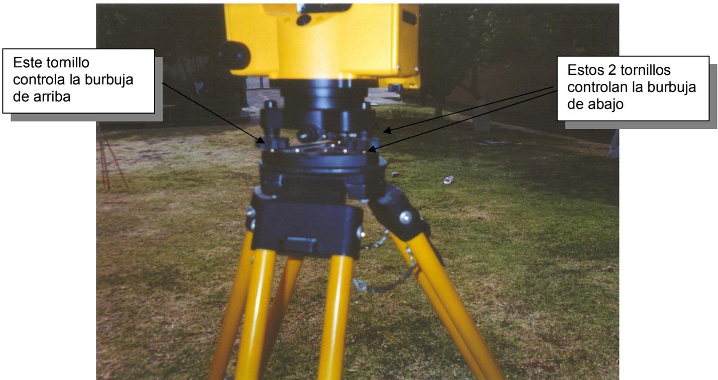
19. Al lograr que las burbujas electrónicas estén dentro del rango permitido, se procede a girar el aparato  $180^\circ$  y se pulsa el botón que queda frente a nosotros.
