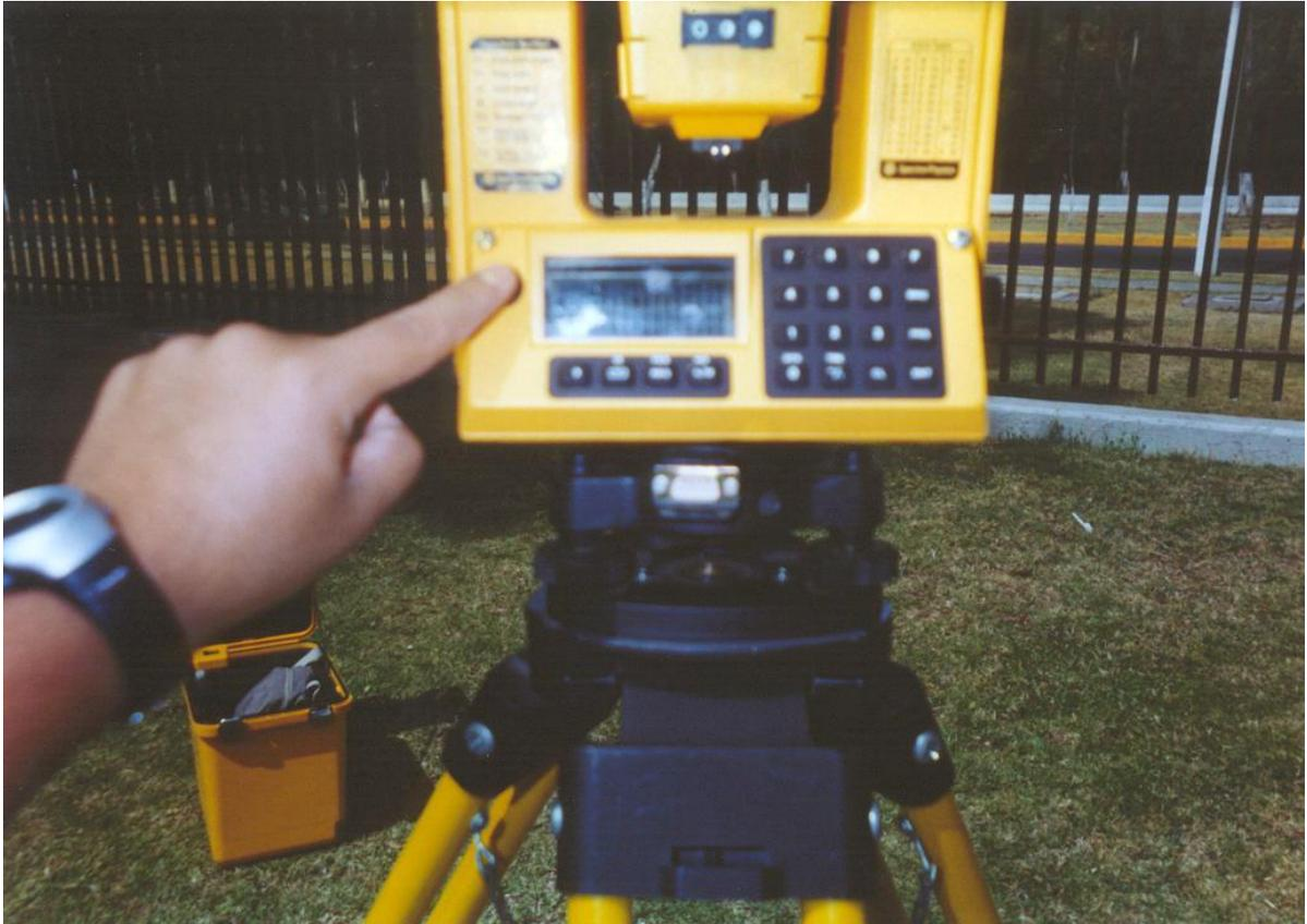
17. Si las burbujas electrónicas están dentro del rango marcado quiere decir que la estación esta nivelada electrónicamente, si una de las burbujas se encuentra fuera del rango marcado en pantalla, la estación no esta nivelada electrónicamente.
