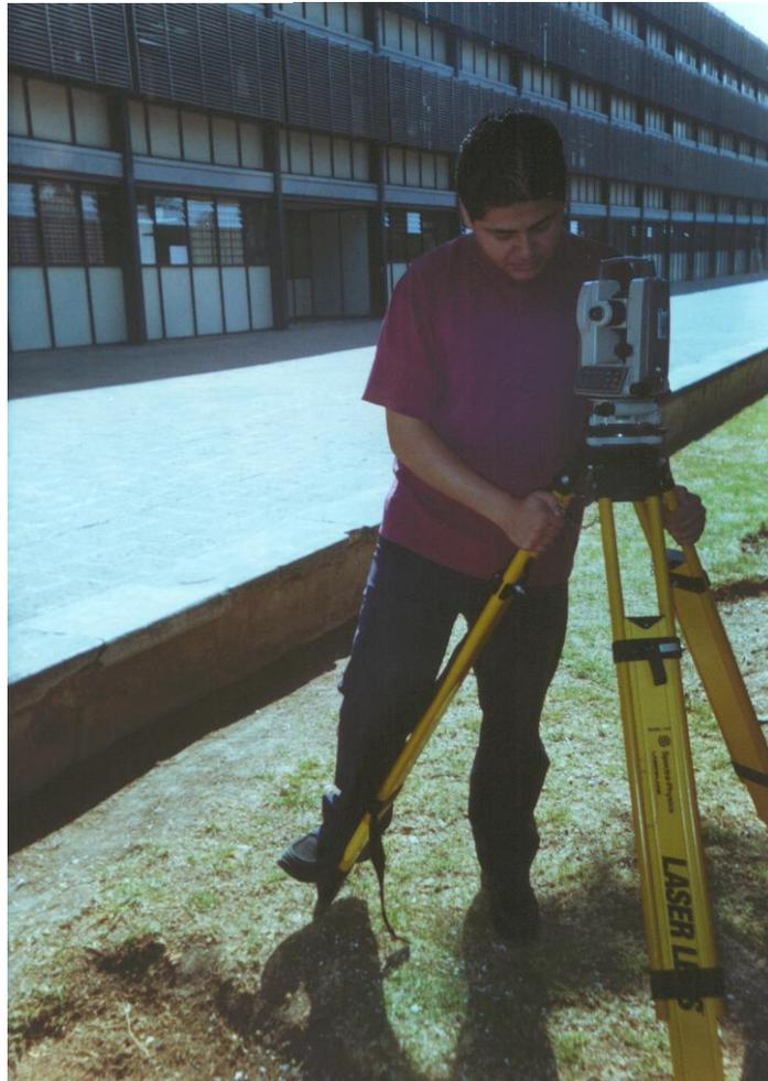
8. En este momento se procede a centrar el teodolito electrónico con mucho más precisión por medio de los tornillos niveladores.
