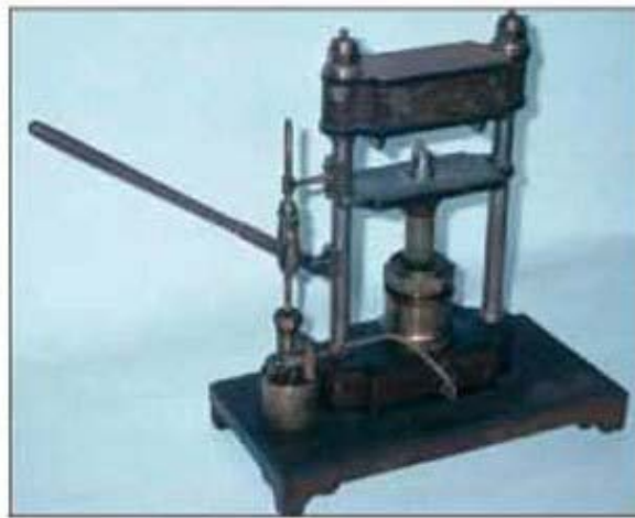
Fig. (1.5) Prensa de fricción para estampado, de principios del siglo XX. Catálogo General de Máquinas-Herramientas 1913 Alfred H. Schütte
