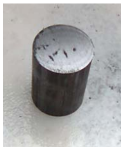
Fig. (3.2) En la imagen se puede ver la pieza de redondo de donde se realizara la tuerca.
