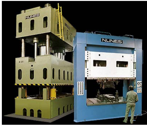
Fig. (1.8) prensas hidráulicas para troquelado en serie.*
