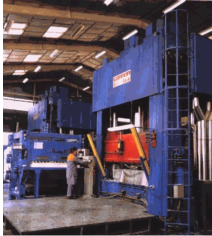
Fig. (1.10) Ejemplo de una prensa dobladora. *
