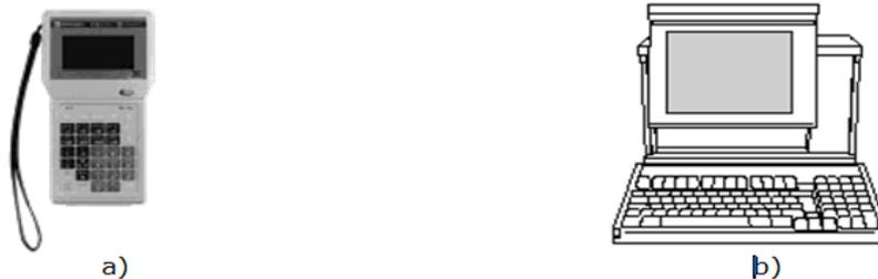
Figura 2.13. a) Terminal de programación portátil. b) Terminal de programación compatible PC.
