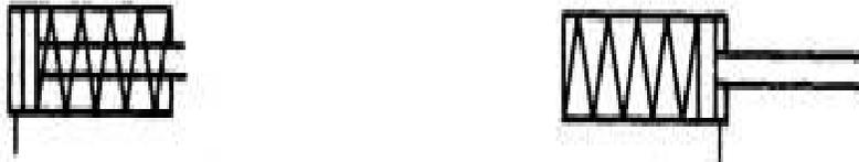
Figura 2.9. Cilindro de simple efecto
