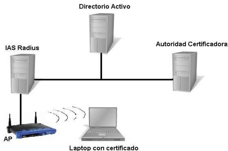
Fig.1. Componentes de una infraestructura RADIUS.
