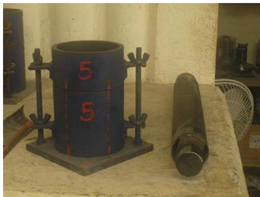
Fotografía No. 51: aquí se observa el equipo utilizado para la prueba proctor (martillo y molde)
