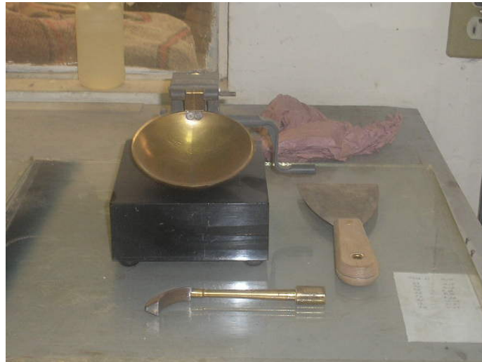
Fotografía No. 49: aquí se observa la copa de casagrande utilizada para la determinación del límite líquido
