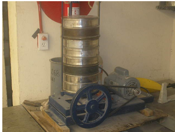
Fotografía No. 46: juego de mallas graduadas utilizadas en la prueba de granulometría
