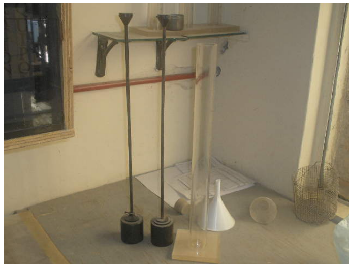
Fotografía No.53: aquí se aprecia el equipo utilizado para la prueba de equivalente de arena
