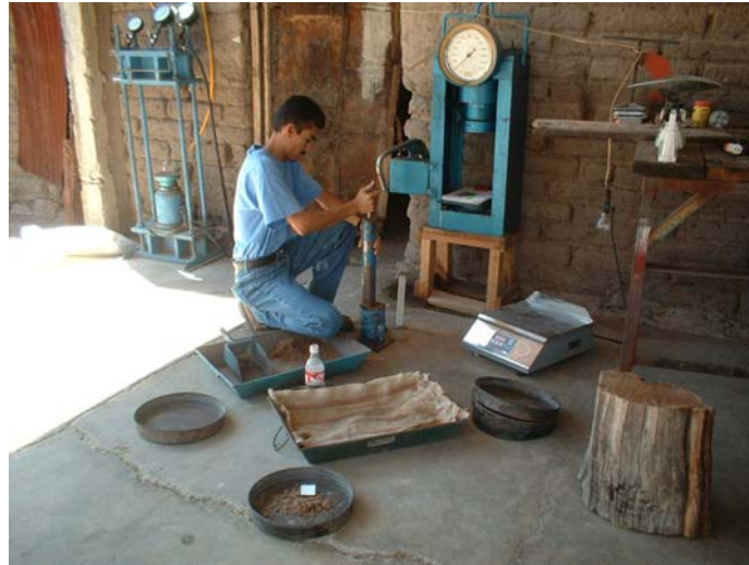
Fotografía No.52: procedimiento de la prueba proctor estándar
