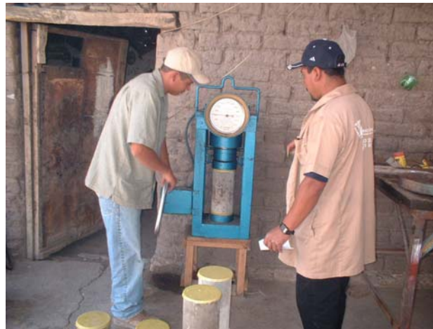
Fotografía No. 58: ensaye de cilindros de concreto ya cabeceados.
