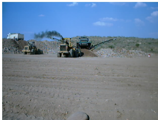
Fotografía 6: cribado de materiales en zona de almacén con maquina cribadora y cargadores frontales
