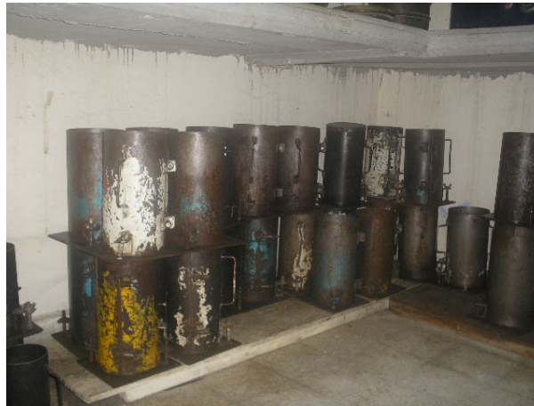
Fotografía No. 55: aquí se aprecian los cilindros que son utilizados para la extracción de muestras de concreto
