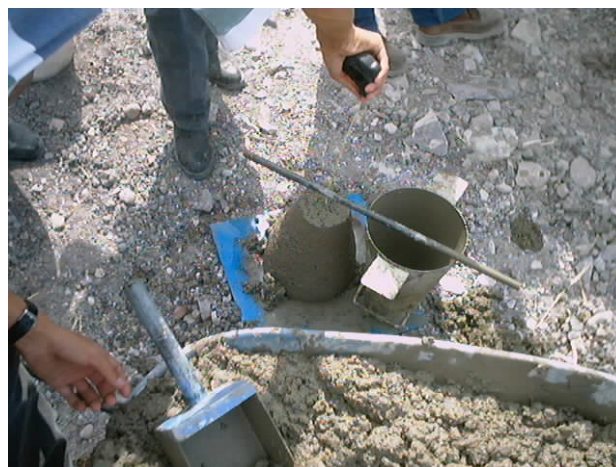
Fotografía No. 54: proceso de la prueba para la determinación del revenimiento del concreto y equipo utilizado
