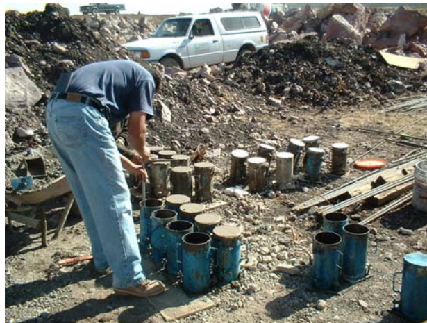
Fotografía No. 56: aquí podemos observar el proceso de la extracción de muestras de concreto. Estos cilindros se deben de dejar en el lugar de muestreo y sin movimiento alguno durante un periodo no menor de 24 horas y sin que sobrepase 48 horas para ser trasladados al laboratorio, ya estando en el laboratorio se descimbran y son sometidos al proceso de curado, hasta la fecha en que son extraídos para su ensaye.
