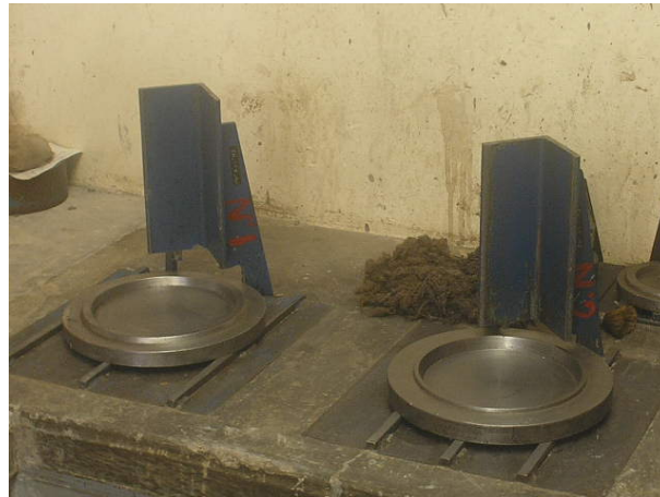
Fotografía No. 57: equipo utilizado para el cabeceo con azufre de cilindros de concreto previo a su ensaye
