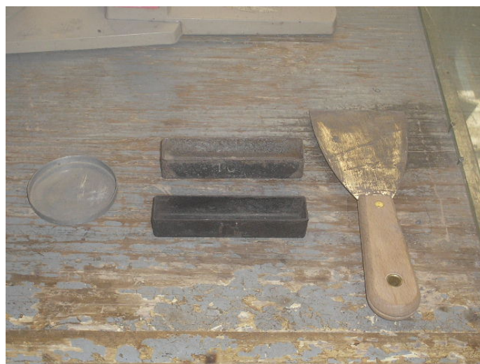
Fotografía No. 50: en esta fotografía se aprecia el molde para la prueba de contracción lineal
